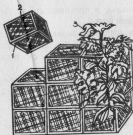
Рис. 30. Моховая стенка: 1 — контейнер из несущих элементов и металлической сетки; 2 — мох или верховой торф; 3 — рассада
