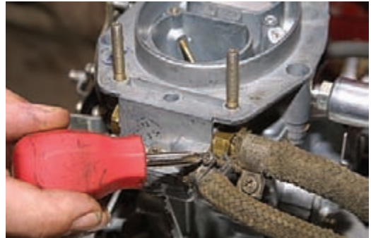
Отверткой ослабляем хомут топливовозвратного шланга и сдвигаем хомут.
