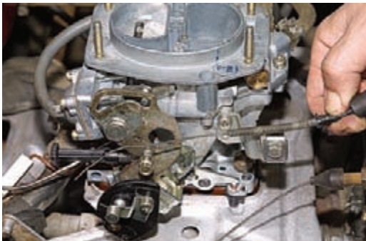
Отсоединяем тягу привода воздушной заслонки от карбюратора.
