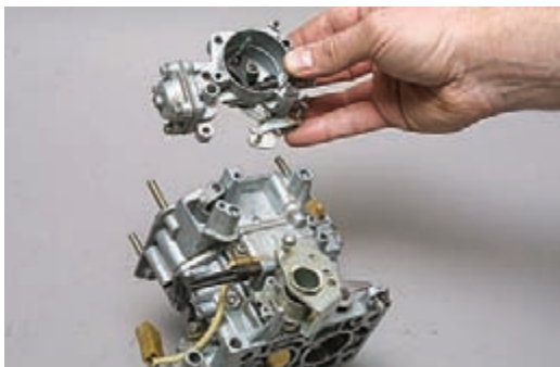
Снимаем пусковое устройство, одновременно отсоединяя тягу от рычага воздушной заслонки.
