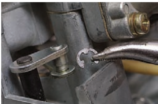
Снимаем стопорную шайбу тяги привода воздушной заслонки.
