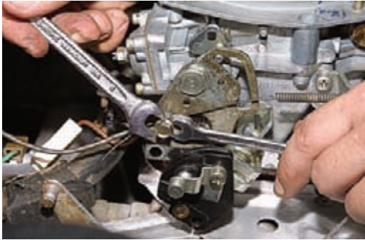
Двумя ключами «на 8» ослабляем затяжку болта крепления тяги привода к рычагу управления воздушной заслонкой.
