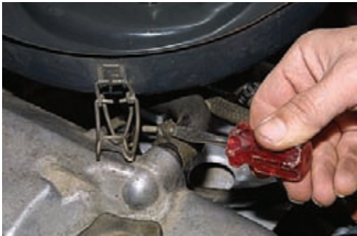
Ослабляем хомут шланга вентиляции картера.
