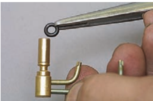
Снимаем с распылителя резиновое уплотнительное кольцо.
