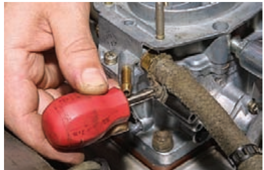
Ослабляем хомут топливоподводящего шланга.
