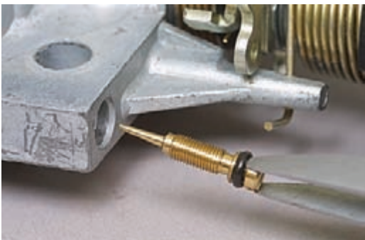
Крючком или узким пинцетом вынимаем винт из канала*.
