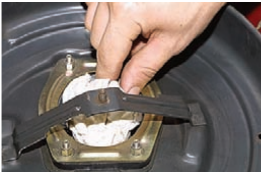
Ослабляем хомут шланга вентиляции картера.
