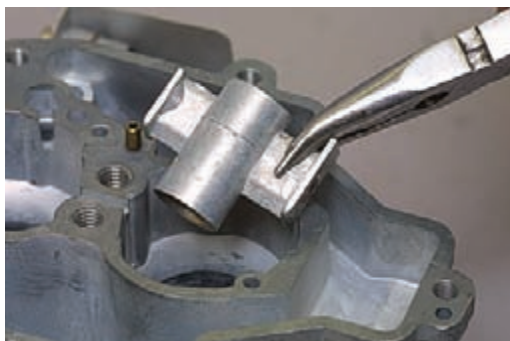
Взявшись плоскогубцами за поперечину, вынимаем малые диффузоры из первой и второй камер.
