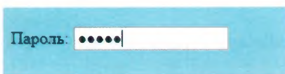
Рис. 9.4. При отображении в браузере символы пароля заменяются маркерами
