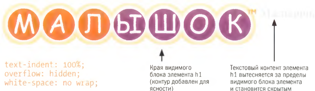
Рис. 18.1. Техника замены текста изображением Скотта Келлама скрывает HTML-текст, сдвигая его за пределы видимого блока элемента с помощью свойства text-indent
