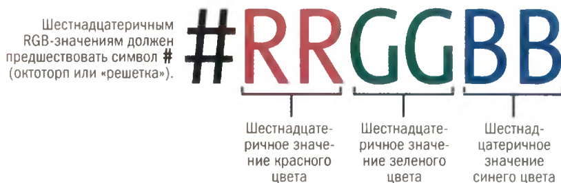
Рис. 13.5. Шестнадцатеричные значения цвета RGB составлены из трех двузначных чисел — по одному для красного, зеленого и синего цветов
