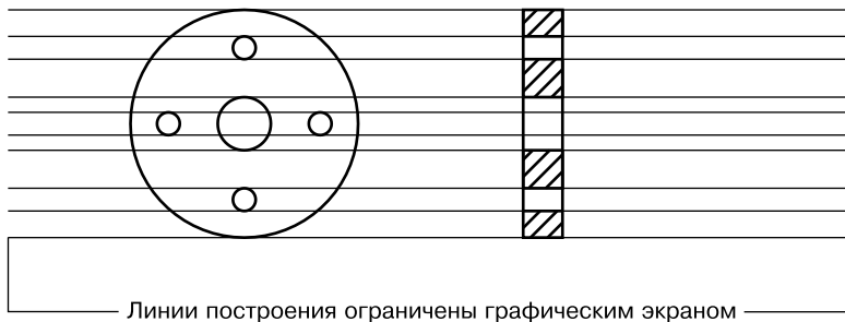
Рис. 2.15. Применение прямых для связи различных проекций одной детали
