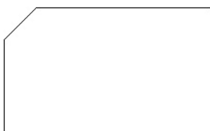
Рис. 6.25. Фаска, созданная методом ввода двух расстояний
