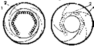
Рис. 73. Влияние диафрагмирования на яркость экрана при направленном освещении: а — диафрагма не закрывает изображение нити накала электролампы; б — изображение нити закрыто диафрагмой — освещенность экрана очень незначительная, хотя относительное отверстие объектива еще достаточно велико
