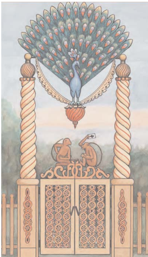
Рис. 242. Арка к двустворчатой калитке. Ширина прохода 135–150 см, габаритная высота 420–540 см
