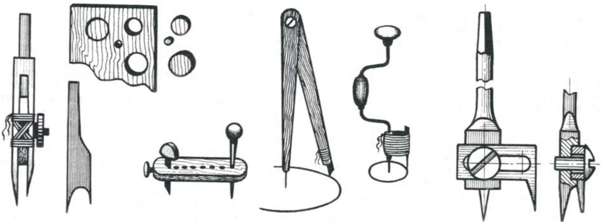
Рис. 5. Самодельные кругорезы для получения прорезей, небольших отверстий или кружков с помощью электродрели или вручную
