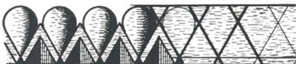
Рис. 95. Изготовление деталей рамы: выполнение полукруглой канавки на плохо гнущемся шпоне; последовательность резьбы на окантовочной планке
