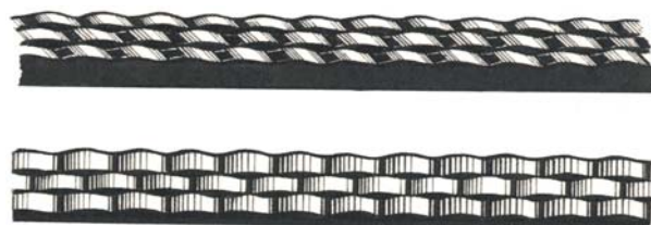
Рис. 23. Три чертёжные линейки, зажатые в тисках в пакете и обточенные напильником, образуют плетёный «ремешок» при смещении средней линейки на полшага
