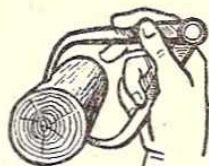
Рис. 28. Измерение кронциркулем и линейкой.
