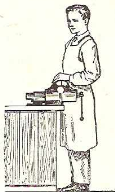
Рис. 83. Определение соответствия высоты слесарного верстака росту ученика.
