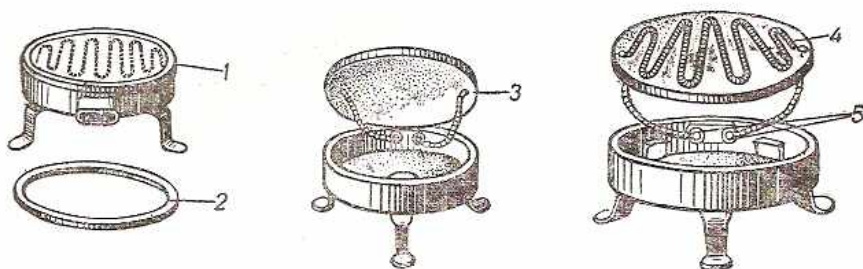
Рис. 149. Электрическая плитка с открытым нагревательным элементом.
