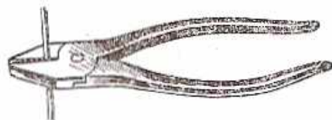
Рис. 53. Выпрямление проволоки плоскогубцами.
