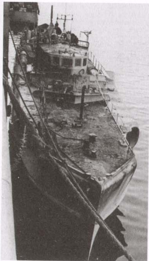
«Шнелльботы» 2-й флотилии в порту Ос-тенде после налета британской авиации, сентябрь 1940 г. Палуба катеров засыпана землей от близких разрывов авиабомб; видны многочисленные повреждения от осколков.
