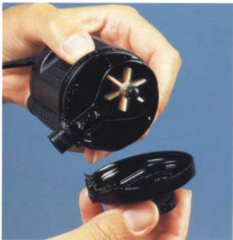
Корпус водяного насоса надо регулярно разбирать и чистить изнутри. Несмотря на высокую скорость течения воды, здесь накапливается осадок, снижающий эффективность системы
