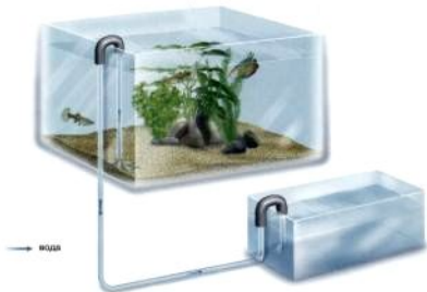
Вода вместе с мусором всасывается у дна аквариума и направляется в расположенный ниже него резервуар (лоток или ведро)
