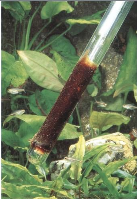
Накипь из карбоната кальция быстро оседает на поверхности обогревателя. Следовательно, необходима регулярная очистка прибора
