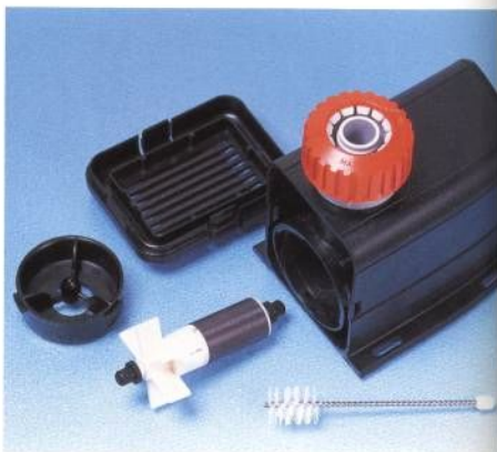
Разобрав для профилактики или ремонта аквариумное оборудование (на снимке — фильтровальный насос), надо прежде всего тщательно его прочистить, например с помощью маленького ершика
