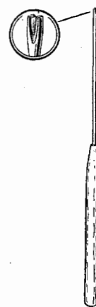
Фиг. 158. Приспособление для изгибания спирали.
