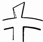
Фиг. 63. Увеличение притяжки путем срезания зуба. Пунктирная линия показывает место среза.
