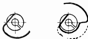
Фиг. 194. Корректировка точки заштифтовки посредством изгиба спирали.
