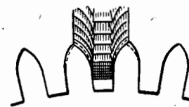
Фиг. 91. Уменьшение диаметра колеса. Пунктирные линии показывают срез.
