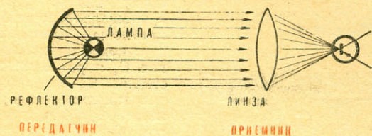
РИС. 7. ПРИНЦИП ДЕЙСТВИЯ УСТАНОВКИ «СВЕТОФОН-3».
