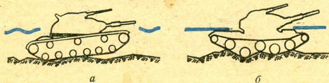
РИС. 2. ХАРАКТЕР ДВИЖЕНИЯ ТАНКОВ: а — с обычной системой подрессоривания; б — с проектируемой системой.
