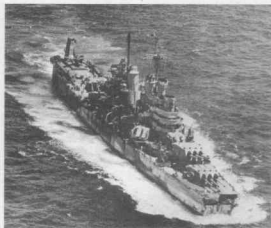
Тяжелый крейсер "Pittsburgh", 10 июня 1945 г. Корабль возвращается в базу после повреждений (оторван нос по первую орудийную башню), полученных во время тайфуна 5 июня 1945 г.
