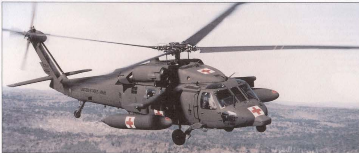
Медицинское снаряжение является стандартным для UH-60L и оборудованного лебедкой UH-60Q (на снимке). Обратите внимание на ПТБ, подвешенные на консолях системы обеспечения дополнительной подвески.
