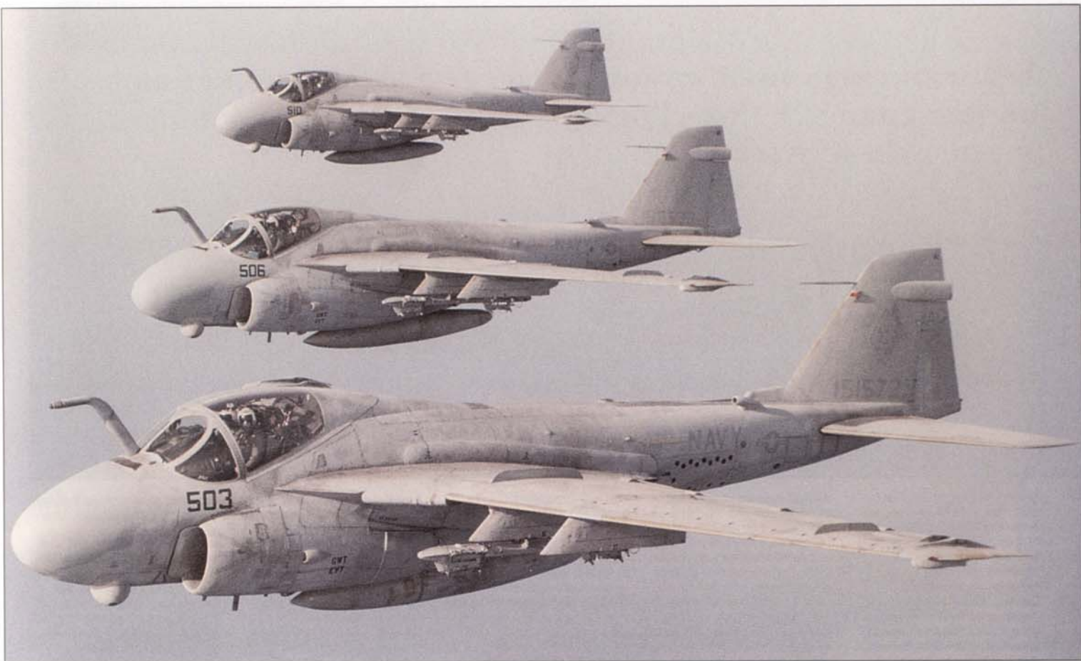
A-6E с турельными установками TRAM под носовыми обтекателями и характерной формой топливозаправочных штанг.
