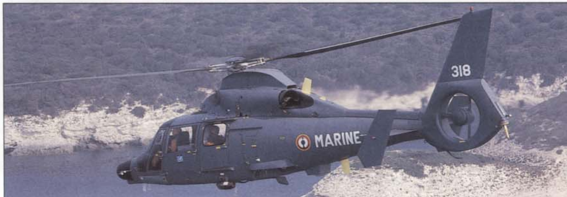
Слева. SA-365F «Дофин» используется в ВМС Франции в качестве палубного вертолета ПЛО и общего назначения, а также вертолета ПСС наземного базирования. На снимке — вертолет из состава 23-й эскадрильи.
