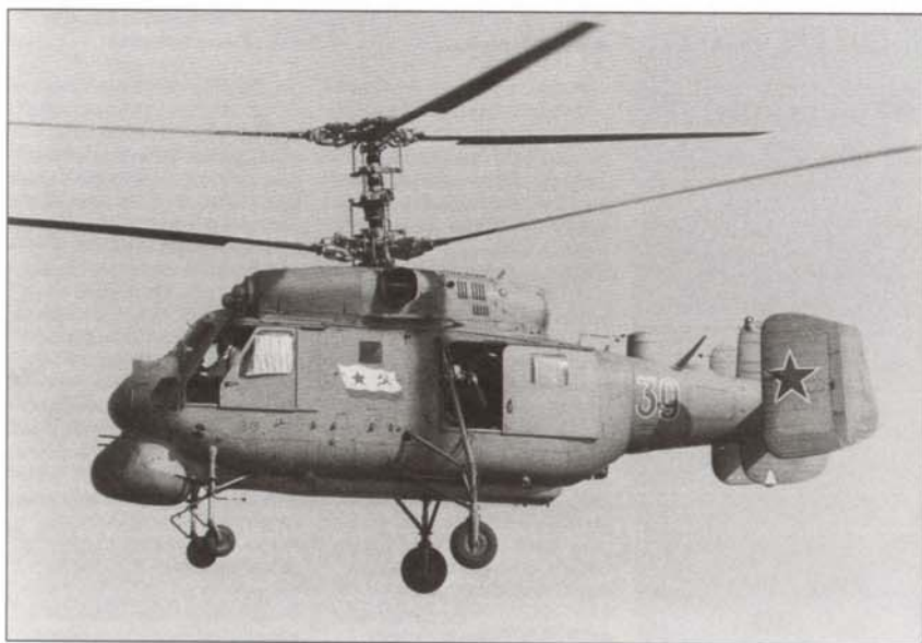
Этот Ka-25БШ с флагом советского Военно-морского флота не имеет оборудования для ПЛО и обеспечения плавучести, а также части топливных баков. В этой конфигурации Ka-25 мог нести груз или 12 пассажиров и использовался для сообщения между кораблями и берегом.
