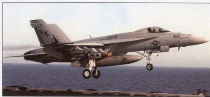
Вверху. «Супер Хорнет» из эскадрильи VFA-115 «Иглс» выполняет взлет с конвейера на авианосце «Абраам Линкольн» в ходе операции «Несгибаемая свобода». Самолеты, аналогичные этому F/A-18E с авиабомбами типа JDAM, позволяют авианосцам США наносить удары с точностью до 13 метров на расстоянии нескольких сотен миль.
