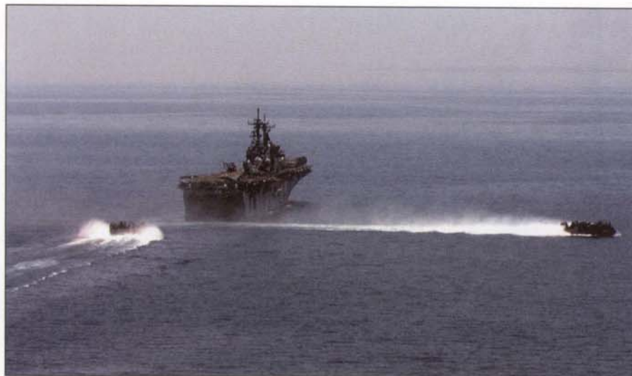
В дополнение к мощному воздушному компоненту УДК типа «Уосп» имеют три ДКАВП (на снимке) или 12 ДКА для перевозки боевой техники типа LCM.
