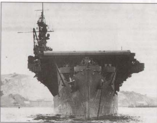
Вверху. Легкий авианосец типа «Индепенденс». Кормовая часть полетной палубы заполнена самолетами. Обратите внимание на четыре дымовые трубы и небольшую надстройку.
