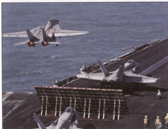
Слева. Этот F-14A из VF-211 взлетел с угловой палубы авианосца ВМС США «Энтерпрайз», а самолеты F/A-18C готовятся к взлету с одной из носовых катапульт корабля. Поднятый отбойник позади переднего «Хорнета» защищает находящиеся сзади самолеты от воздействия реактивной струи, что особенно важно при использовании форсажа.
