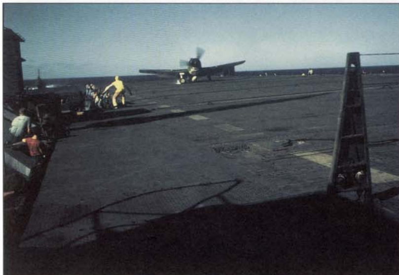
Слева. «Хеллкэт» совершает посадку с подломленной основной стойкой шасси. Прочная конструкция истребителя позволяла самолету благополучно завершить посадку, даже если в ходе нее происходили определенные поломки.
