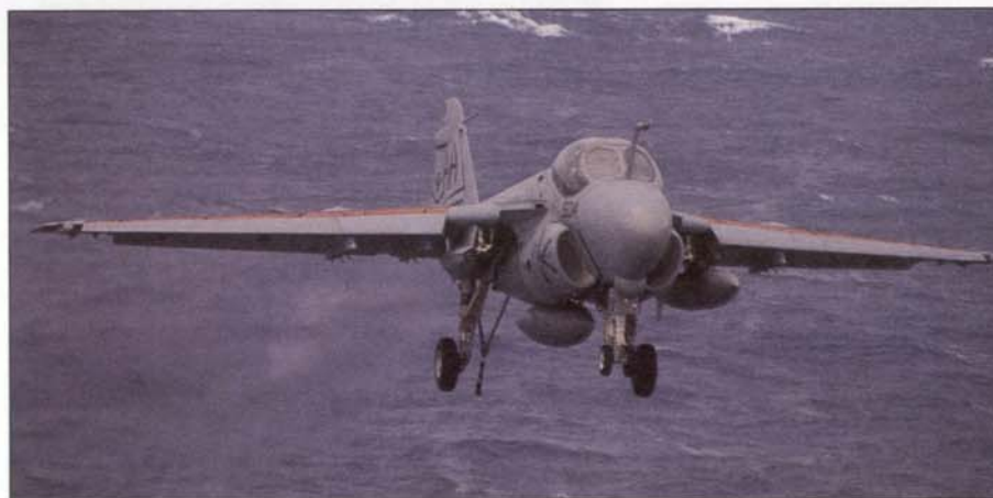
A-6E с турельными установками TRAM под носовыми обтекателями и характерной формой топливозаправочных штанг.
