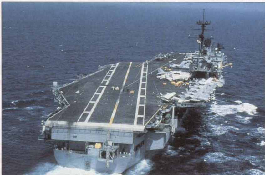
Корабль ВМС США «Саратога», первый из авианосцев, прошедших переоборудование по программе SLEP. Корабли этого типа были первыми авианосцами, на которых ангары и полетные палубы являлись составными элементами корпуса, а АУ находились на бортовых спонсонах.
