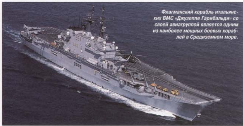
«Джузеппе Гарибальди» имеет восемь ПУ противокорабельных ракет «Тесео» Mk2 и две восьмиконтейнерные ПУ «Альбатрос» для 48 ЗУР «Аспид».
