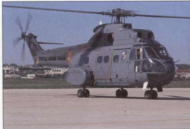
Построенные по лицензии машины IAR-330 составляют основу вертолетного парка румынских ВВС. Обратите внимание на увеличенные выступы на бортах фюзеляжа.
