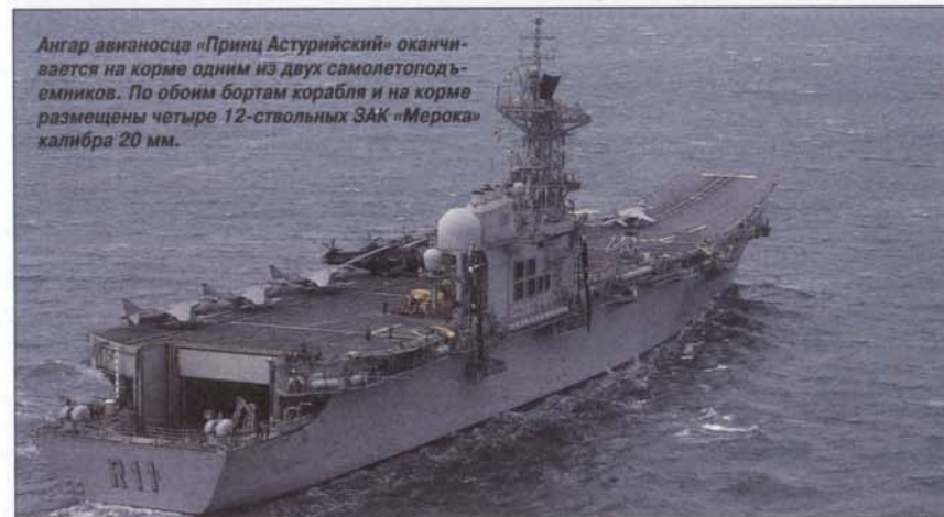
«Принц Астурийский» имеет прямую полетную палубу и крутой трамплин в носовой части корабля для взлета самолетов «Харриер-2» с максимальной боевой нагрузкой.
