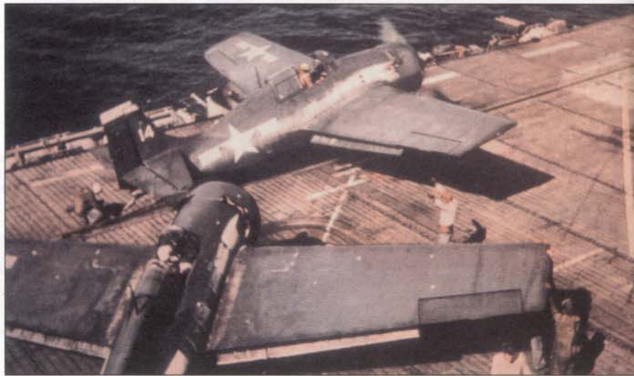
Вверху. Одним из самых очевидных отличий FM-2 от остальных модификаций самолета «Уайлдкэт» был более высокий киль и руль направления.
