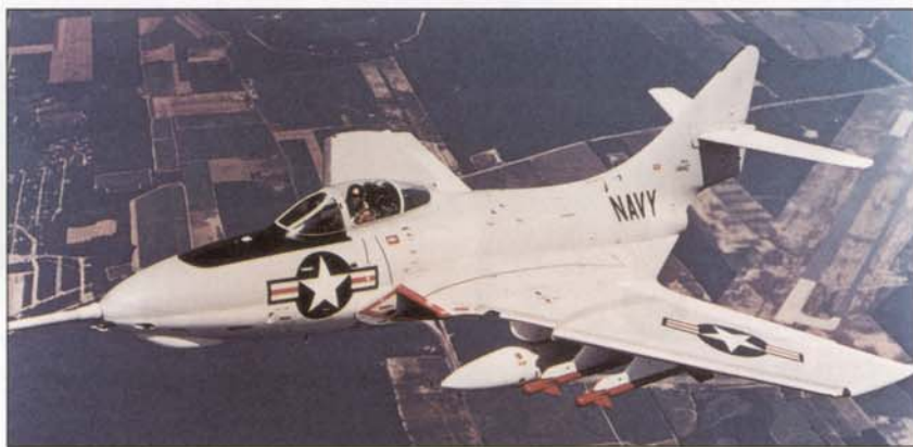
Этот F9F-8T с опознавательными знаками принадлежности к учебному подразделению номер 206 имеет фюзеляж, удлинненный на 86,36 см, для размещения второй кабины.
