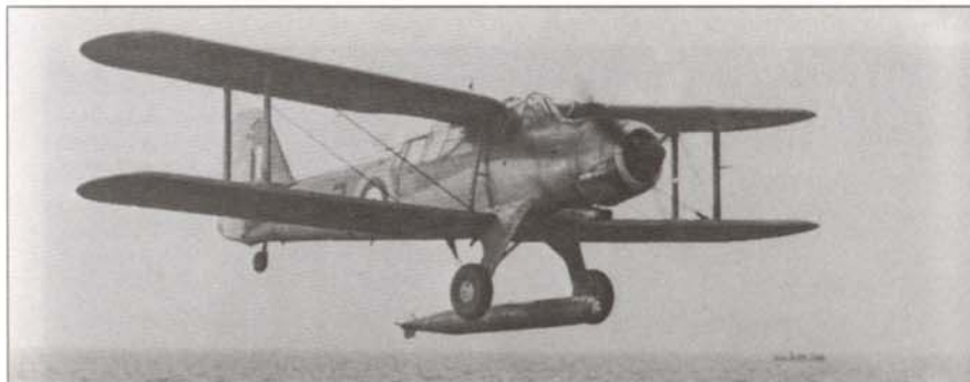
«Альбакор» служил хорошо, но неприметно, особенно в Северной Африке и на Средиземноморье. Этот самолет сфотографирован в момент сброса 457-мм учебной торпеды.
