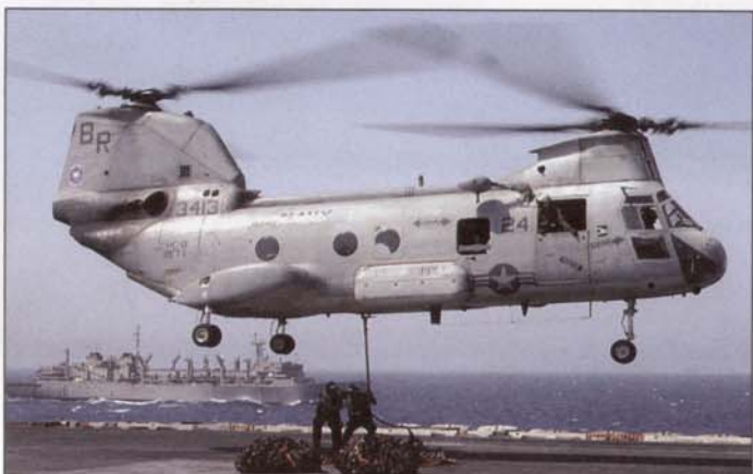
Внизу. CH-46 «Си Найт» эскадрильи HC-8 «Дрегон Уэйлс» доставляет груз с быстрого универсального транспорта снабжения «Сэплай» командования морских перебросок ВМС США на авианосец «Джордж Вашингтон» в ходе операции «Несгибаемая свобода». Даже последняя модификация этого вертолета, CH-46E, уже давно подлежит списанию. В ходе недавних операций с авианосцев применялись также вертолеты CH-53 морской пехоты ВМС США.
