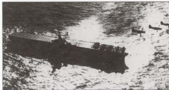
Вверху. Авианосец ВМС США CV-4 «Рейнджер», 1942 год. Корабль спроектирован гладкопалубным, но в процессе строительства на нем была установлена небольшая надстройка.
