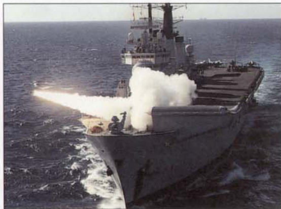
Основным зенитным вооружением дальнего радиуса действия авианосцев типа «Инвинсибл» являлись ЗУР «Си Дарт», размещавшиеся в двухконтейнерной ПУ перед полетной палубой.
