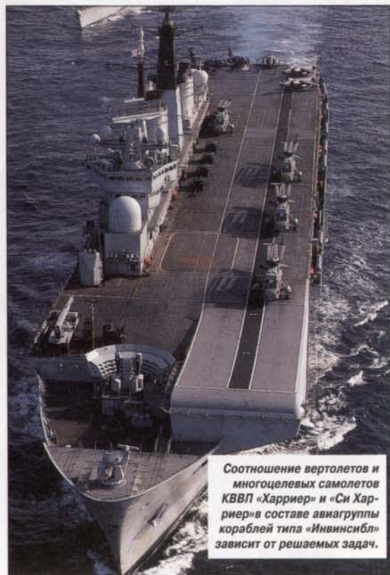
Основным зенитным вооружением дальнего радиуса действия авианосцев типа «Инвинсибл» являлись ЗУР «Си Дарт», размещавшиеся в двухконтейнерной ПУ перед полетной палубой.
