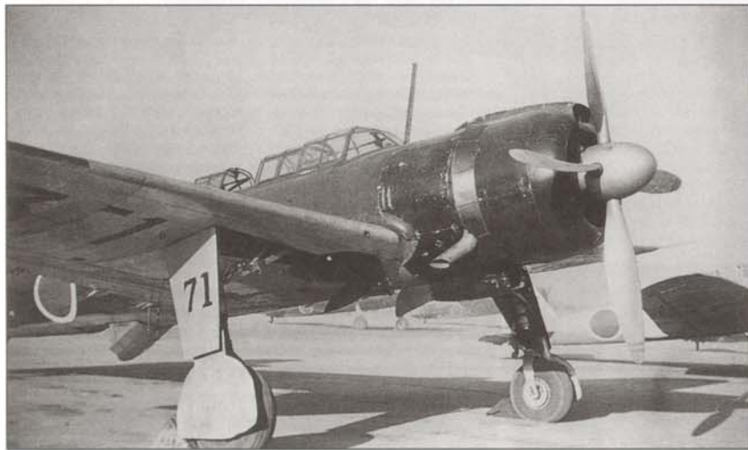
Слева: компания «Накадзима» стремилась использовать на B6N собственные двигатели «Мамору 11», но их производство было прекращено после выпуска 135 самолетов B6N. Более поздние самолеты оснащались двигателями «Касей».
