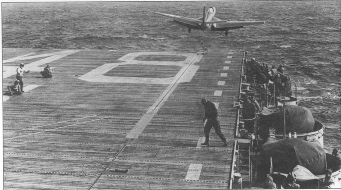
На авианосце ВМС США «Сайпан» в мае 1948 года после проведения серии испытаний была развернута первая в мире эскадрилья реактивных палубных истребителей. На снимке представлен один из них, FН-1 «Фантом», производства компании «Макдоннелл». Обратите внимание на отделяющийся от «Фантома» строп, связывавший самолет с катапультной.
