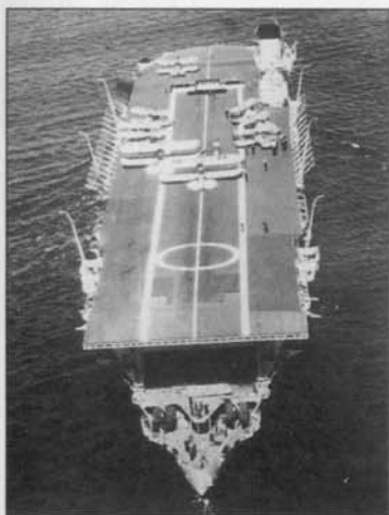
Внизу. Корабль ВМС Великобритании «Глориес» был одним из двух довольно посредственных авианосцев, перестроенных из легких линейных крейсеров в 20-е годы XX века.
