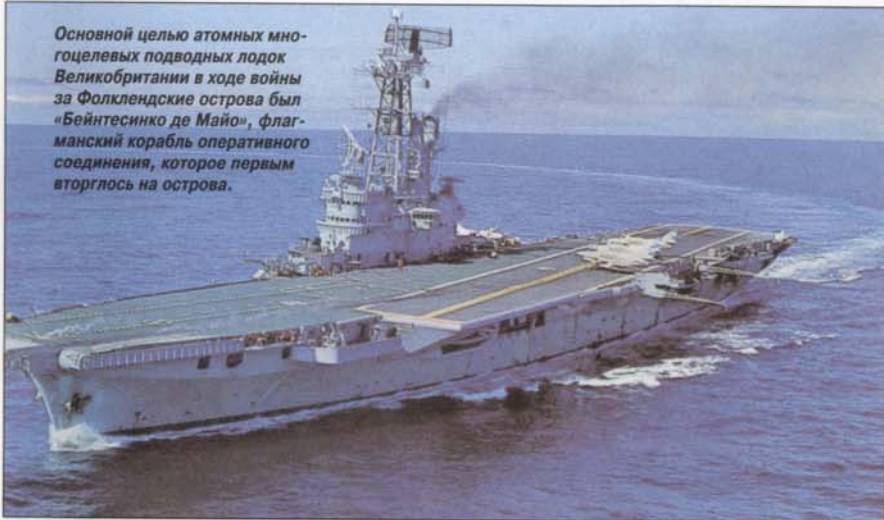
В середине 80-х годов конструкция палубы «Бейнтесинко де Майо» обеспечивала применение самолетов A-4Q «Скайхок» и «Супер Этандар». Идущий от катапульты пар, свидетельствует о том, что с полетной палубы только что взлетел самолет.
