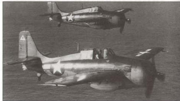
Вверху. Одним из самых очевидных отличий FM-2 от остальных модификаций самолета «Уайлдкэт» был более высокий киль и руль направления.
