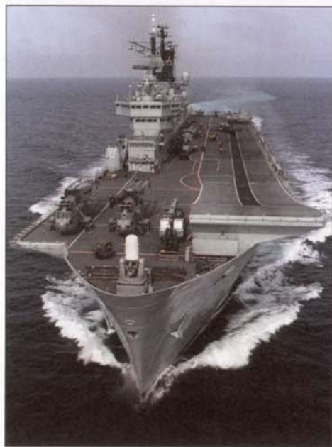
Войдя в строй в 1985 году, третий корабль типа «Инвинсибл» «Арк Ройал» обеспечивает постоянное нахождение в боевом составе ВМС Великобритании двух авианосцев и еще одного — в резерве или на переоборудовании. На носу корабля хорошо виден ЗАК «Фаланкс».
