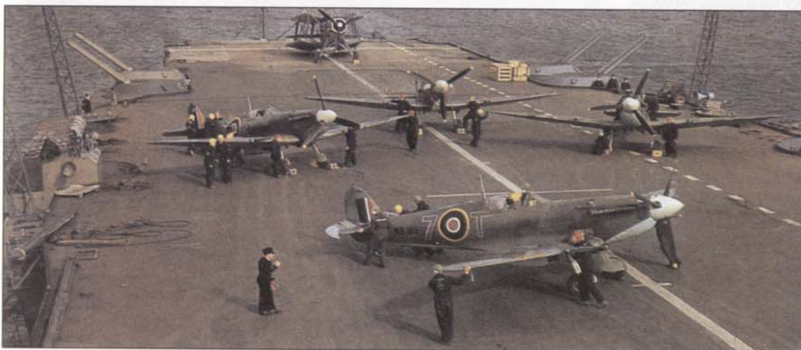
Вверху. Этот «Сифайер» F.Mk1B принадлежал 760-й эскадрилье авиации ВМС Великобритании. Самолет имел узкоколейное шасси для маневрирования на тесной палубе.
