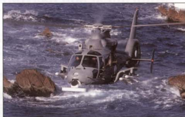
Внизу. AS-565SB несет максимальную нагрузку для вертолетов этого типа (четыре ПКР AS.15TT) и противокорабельную РЛС с антенной в обтекателе снизу в носовой части фюзеляжа.
