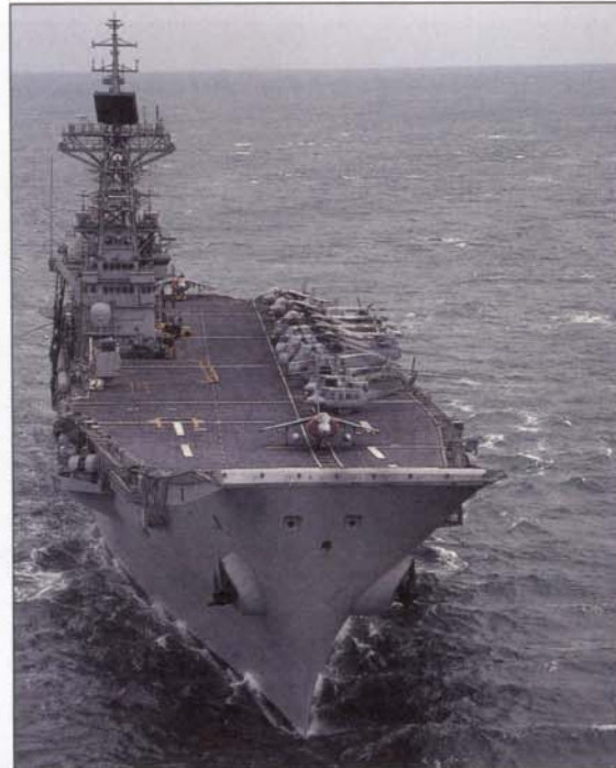
«Принц Астурийский» имеет прямую полетную палубу и крутой трамплин в носовой части корабля для взлета самолетов «Харриер-2» с максимальной боевой нагрузкой.
