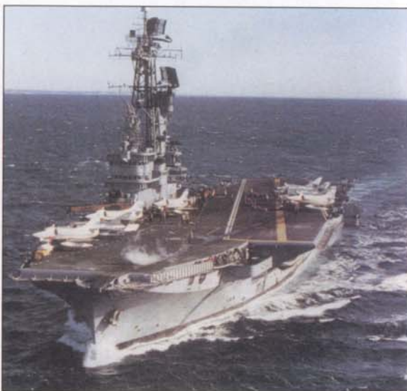
В середине 80-х годов конструкция палубы «Бейнтесинко де Майо» обеспечивала применение самолетов A-4Q «Скайхок» и «Супер Этандар». Идущий от катапульты пар, свидетельствует о том, что с полетной палубы только что взлетел самолет.
