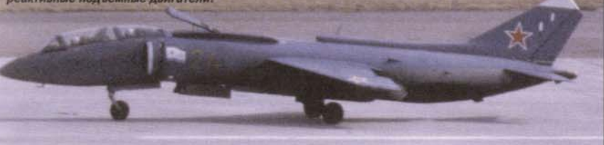
Як-38У демонстрирует свои удлиненные контуры. Воздухозаборник позади кабины подает воздух в размещенные впереди реактивные подъемные двигатели.
