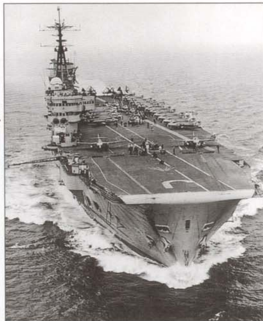
«Игл» с самолетами «Си Хок» и «Уайверн» на палубе, 1956 год. Обратите внимание на расположенные в носовой части корабля на уровне полетной палубы спаренные 114-мм зенитные АУ, а также готовые к взлету с носовых катапульт самолеты «Си Хок». Эти самолеты имеют опознавательные знаки принадлежности к 897-й эскадрилье, в которую входили самолеты FB. Mk3 и FGA. Mk6. Во время суэцкого кризиса в октябре 1957 года они были заменены самолетами FGA. Mk6 из состава 895-й эскадрильи.
