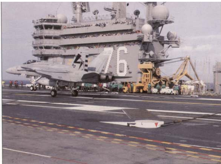
Вверху. 24 июля 2003 года «Хорнет» из состава VX-23 совершил первую посадку с использованием аэрофинишера на палубу корабля «Рональд Рейган» (CVN-76).
