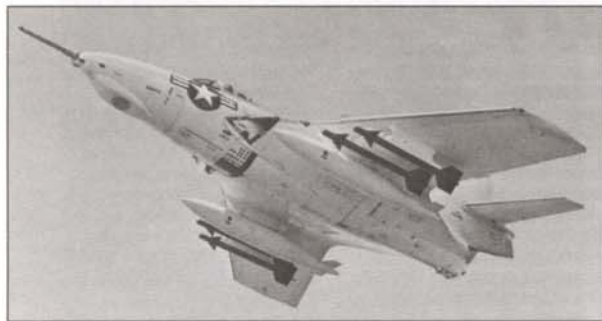
Вверху. F9F-8 «Кугар» с крылом большой площади и малого удлинения несет четыре новые ракеты класса «воздух-воздух» «Сайдвиндер» и два топливных бака на подкрыльевых пилонах. F9F-8 также выпускался в разведывательной модификации F9F-8P.
