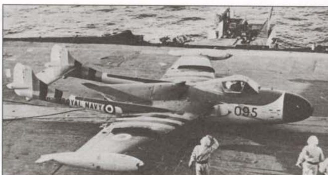
«Си Веном» активно использовался в ВМС Великобритании в течение шести — семи лет. Его наиболее важное боевое применение произошло в ходе суэцкого кризиса, когда изображенный на снимке FAW.Mk21 произвел посадку с убранным шасси. Над галом хорошо виден обтекатель.
