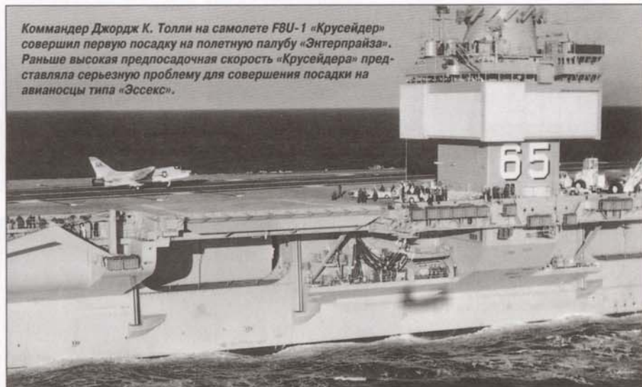
Оригинальная прямоугольная островная надстройка «Энтерпрайза» была предназначена для размещения радиолокационного комплекса SPS-32/33.
