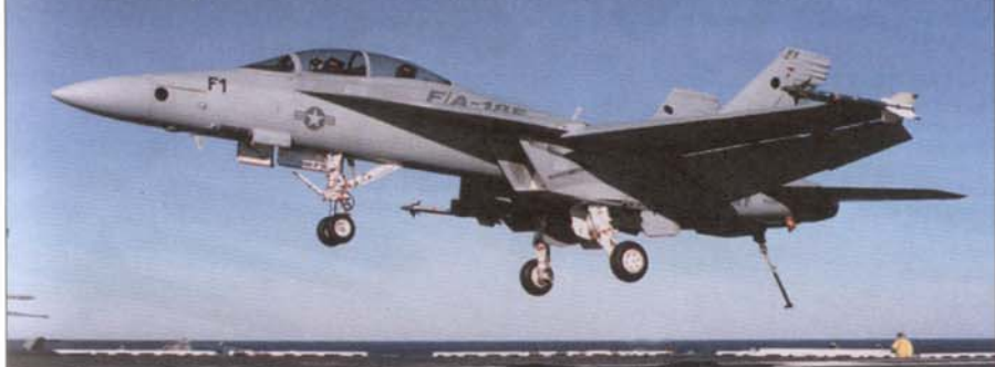
F/A-18F (вверху) и F/A-18C выполняют маневрирование в ходе испытаний. «Супер Хорнет» можно легко отличить от «Хорнета» по квадратным входам воздухозаборников и увеличенным наплывам в корневой части крыла.
