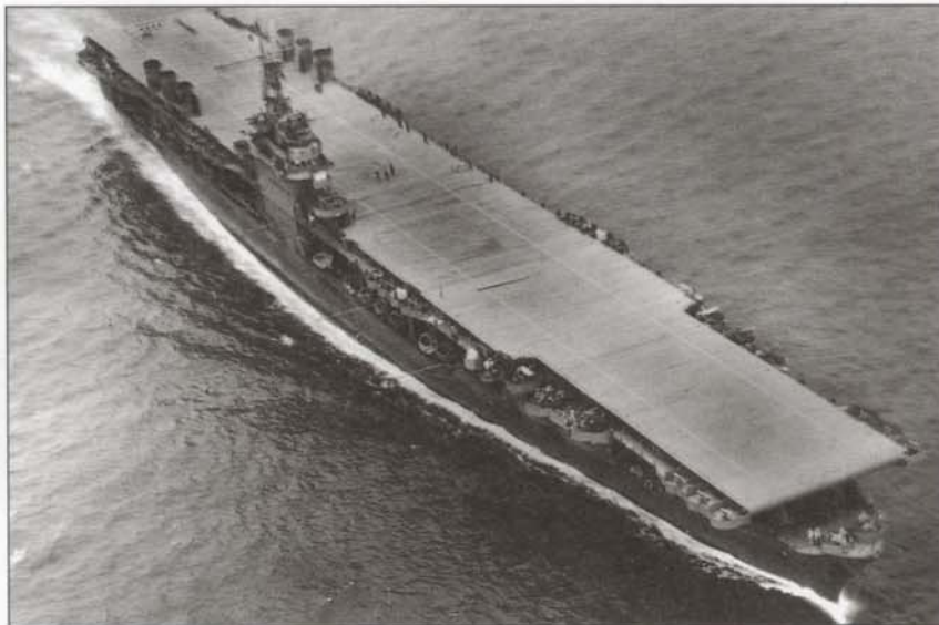
Вверху. Авианосец ВМС США CV-4 «Рейнджер», 1942 год. Корабль спроектирован гладкопалубным, но в процессе строительства на нем была установлена небольшая надстройка.
