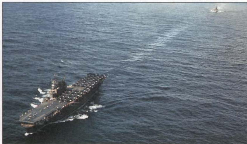
Внизу. Более крупные, чем их предшественник «Рейнджер», авианосцы «Энтерпрайз» и «Йорктаун» имели скорость на 4 узла больше и обладали превосходными мореходными качествами.
