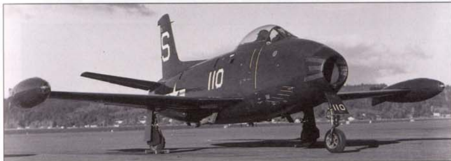
Слева. FJ-1 был оснащен турбореактивным двигателем J35, и компоновка самолета предусматривала сквозное течение воздуха через осевой воздухозаборник, двигатель и сопло. FJ-1 стал первым реактивным самолетом, поступившим на вооружение резерва ВМС.
