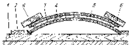
Рис. 47. Приспособление для формовки стекла: 1—стол; 2—упорные бруски; 3—матрица; 4—стекло; 5—лист; 6—вспомогательные бруски
