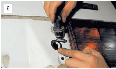
Снимаем привод замка, под которым расположено уплотнительное резиновое кольцо.
