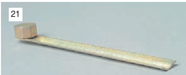
21 Ключ с восьмигранником «на 17» для регулировки рулевого механизма.
