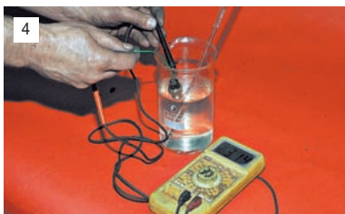
Измеряем сопротивление датчика при разных температурах.
