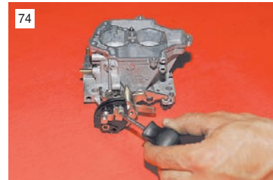
74 Крестообразной отверткой отворачиваем винт крепления сектора и рычага управления дроссельными заслонками...
