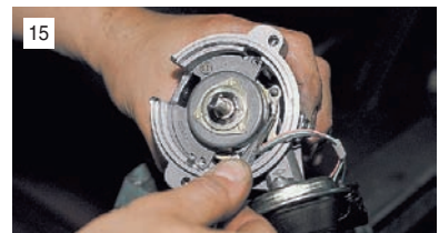
15 Снимаем стопорную шайбу тяги вакуумного регулятора...
