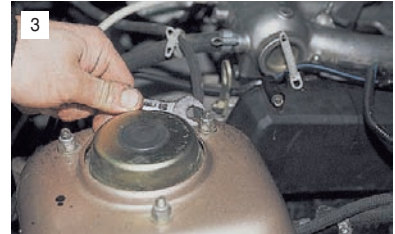
3 Ключом "на 13" отворачиваем три гайки крепления верхней опоры к кузову...
