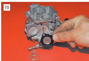
70 ...снимаем ее вместе с возвратной пружиной.
