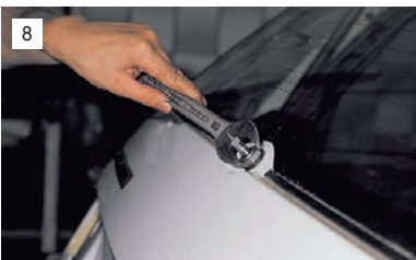
8 Ключом "на 24" отворачиваем гайку.
