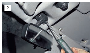
2 Крестообразной отверткой открываем два самореза крепления зеркала...
