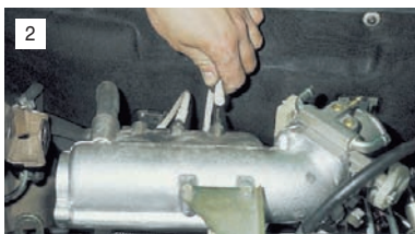
2 ...электропневмоклапана и регулятора давления топлива в топливной рампе.
