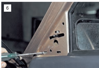
6 Крестообразной отверткой отворачиваем три самореза крепления зеркала...
