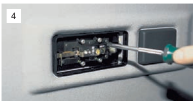
4 ...крестообразной отверткой отворачиваем четыре самореза.
