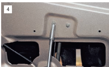
4 Головкой "на 10" отворачиваем две гайки среднего крепления направляющей механизма стеклоподъемника,...
