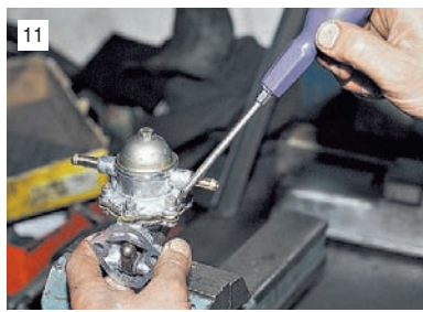
11 Крестообразной отверткой отворачиваем шесть винтов, соединяющих верхний и нижний корпуса насоса.
