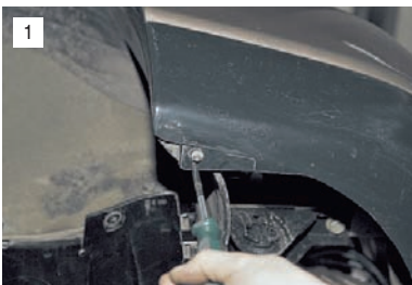
Крестообразной отверткой отворачиваем два самореза (по одному с каждой стороны) нижнего крепления подкрылков к бамперу...
