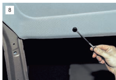
Поддеваем отверткой три фиксатора заднего крепления обивки крыши.
