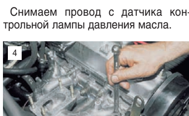
Ключом "на 13" отворачиваем две гайки крепления патрубка забора горячего воздуха и рыва.
