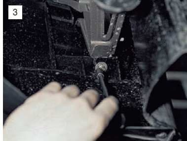
Снизу головкой "на 8" отворачиваем два болта крепления бампера к кронштейнам.
