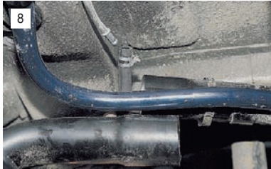
8 ...и снимаем шланг, придерживая металлическую трубку, чтобы не погнуть.
