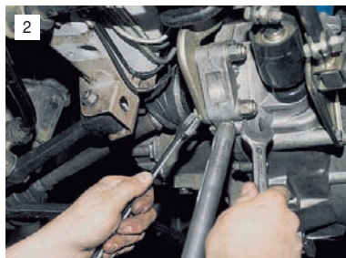
2 Двумя ключами «на 19» отворачиваем два болта крепления опоры к коробке передач...
