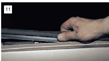
11 Снимаем наружный уплотнитель опускаемого стекла,...
