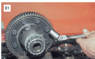
91 Головкой "на 17" отворачиваем восемь болтов крепления шестерни к коробке дифференциала.
