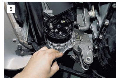
Ключом "на 13" отворачиваем гайку нижнего крепления генератора.
