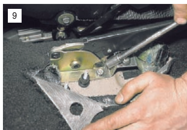
9 Головкой "на 10" отворачиваем четыре болта крепления кронштейна рычага к полу.
