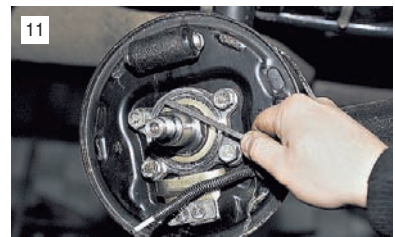
11 После работы зубилом на оси ступицы появляются заборозины, которые устраняем надфилем.
