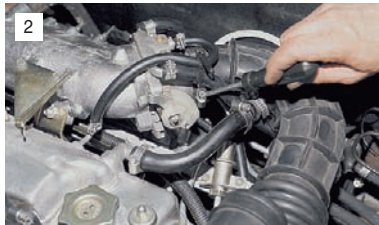
Ослабляем хомут крепления воздушного шланга к дроссельному патрубку...
