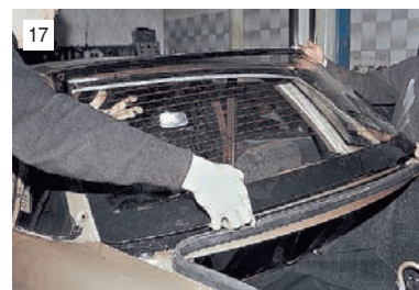
Прикладываем стекло с окантовкой к оконному проему, обеспечивая равномерность зазоров с панелями кузова.
