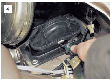
Крестообразной отверткой отворачиваем саморезы держателей защитного чехла педали сцепления...
