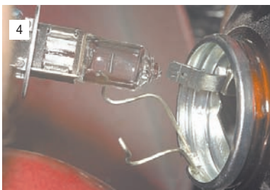
Выводим лампу из отверстия в отражателе.
