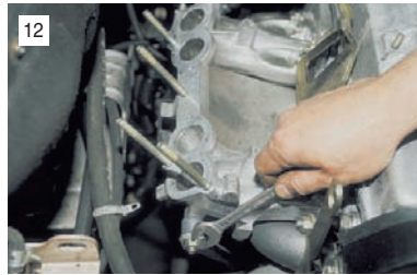
Ключом "на 13" отворачиваем гайку верхнего крепления правого кронштейна коллектора...
