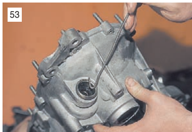
53 Для замены сальника штока выбора передач поддеваем его крючком из толстой проволоки и извлекаем из втулки.
