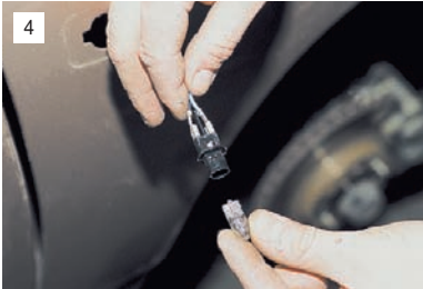
4 Сдвинув чехол, заменяем лампу.
