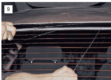
Распилив струной клеевой шов по всему периметру, вынимаем стекло.
