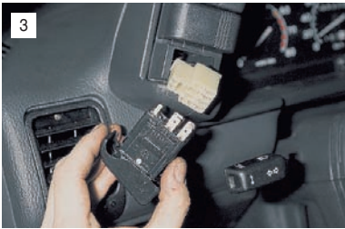
Вынимаем переключатель наружного освещения и отсоединяем от него разъем.
