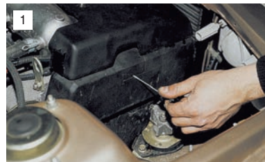
1 Для оценки состояния ремня поддеваем отверткой заглушку передней крышки ремня привода ГРМ...
