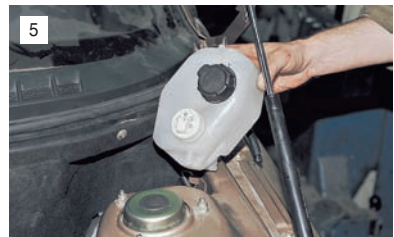
5 Отстегнув резиновый ремень крепления, снимаем расширительный бачок.
