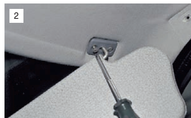
2 ...и два самореза крепления петли.
