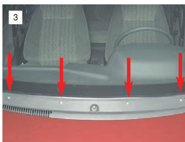
Крестообразной отверткой отворачиваем четыре самореза крепления облицовки, расположенные под заглушками (показаны стрелками).
