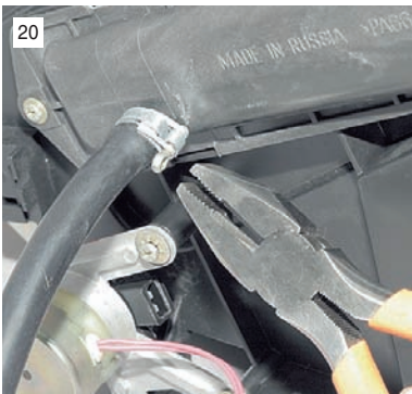
...ослабляем затяжку хомута...
