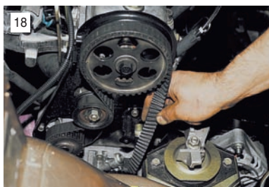
18 При нормальном натяжении ремня его передняя ветвь должна закручиваться на 90° большим и указательным пальцами руки с усилием 15–20 Н (1,5–2,0 кгс).
