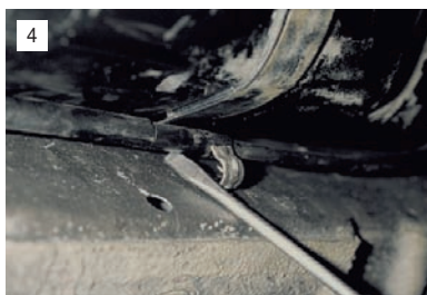
4 Отверткой отгибаем три скобы крепления оболочки троса к кузову.
