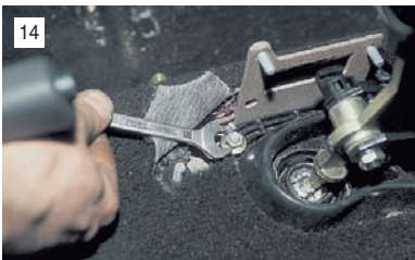
14 Ключом "на 10" отворачиваем шесть гаек крепления к кузову прижимной пластины привода.
