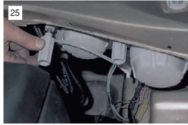
Винты регулировки пучка света в горизонтальной...
