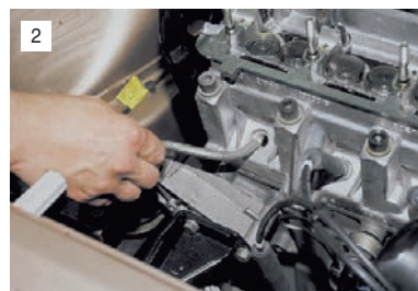
Через свечное отверстие вставляем пруток из мягкого металла (диаметром около 8 мм) между днищем поршня и тарелкой клапана, на котором меняем колпачок.
