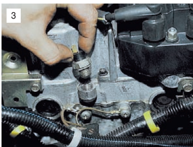
3 Уплотнение датчика – алюминиевым кольцом.
