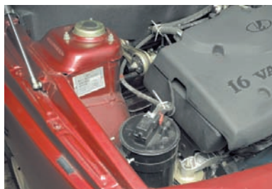
Данные об автомобиле приведены в табличке, закрепленной на правой чашке опоры телескопической стойки.
