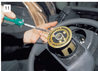
11 ...крестообразной отверткой отворачиваем три винта и снимаем кольцо.
