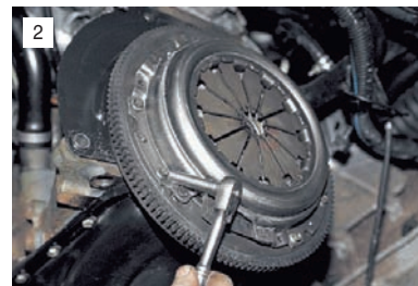
Для отворачивания болтов можно также воспользоваться головкой "на 8".
