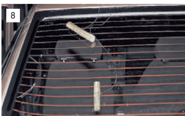
Продвигаем через отверстие струну и прикрепляем к ее концам держатели.
