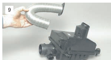
Отворачиваем и снимаем с патрубка корпуса фильтра воздухозаборный шланг.
