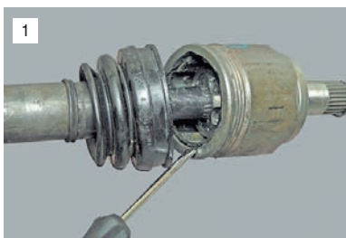
Отверткой поддеваем фиксатор внутреннего шарнира...
