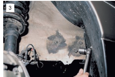
Головкой "на 17" отворачиваем три болта крепления кронштейна к правому лонжерону.
