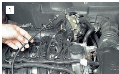
Отсоединяем и отводим в сторону трос привода дроссельной заслонки.
