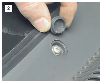
...и снимаем четыре заглушки, под которыми расположены саморезы крепления облицовки.
