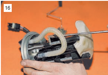
16 Отверткой выводим два фиксатора...
