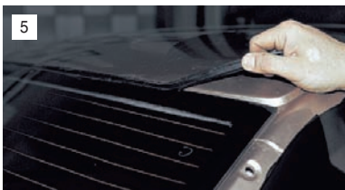
Снимаем окантовку стекла.
