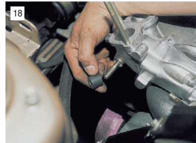
Снимаем со шпильки впускного коллектора втулку.
