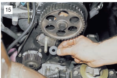
15 Под роликом установлена дистанционная шайба.
