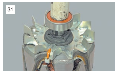
...и напрессовываем подшипник на задний конец вала оправкой или отрезком трубы подходящего диаметра, прикладывая усилие только к внутреннему кольцу подшипника.
