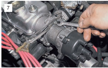
7 Ключом "на 10" отворачиваем гайку верхнего крепления датчика-распределителя...
