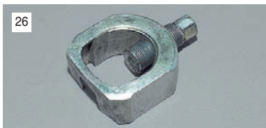
26 Съемник шаровых опор.
