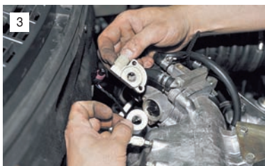
...и снимаем датчик с прокладкой.
