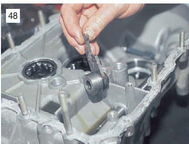
48 Снимаем рычаг выбора передач со штока.
