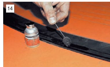
Наносим грунт (праймер) на стекло...
