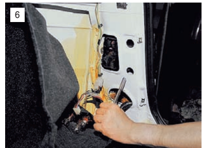
6 Головкой "на 8" отворачиваем три гайки крепления фонаря к кузову.
