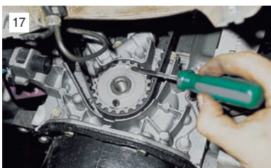
17 При снятом шкиве привода генератора положение коленчатого вала удобно контролировать по совмещению меток на зубчатом шкиве коленчатого вала и крышке масляного насоса (см. рис.).
