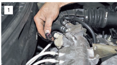
При выключенном зажигании отсоединяем электрический разъем датчика.
