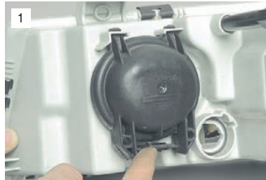
1 ...нажимаем (движением вверх) фиксатор защитной крышки лампы, расположенной ближе к продольной оси автомобиля...
