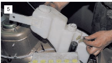
Приподняв бачок, отсоединяем провода...
