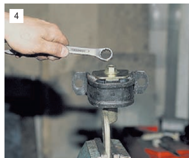
4 ...ключом «на 19» отворачиваем болт, зажав кронштейн в тиски.
