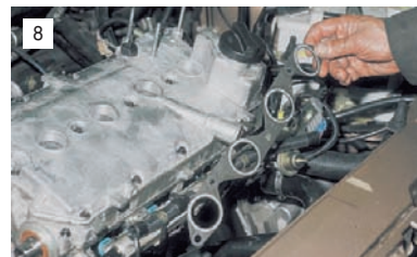
...и прокладку коллектора.
