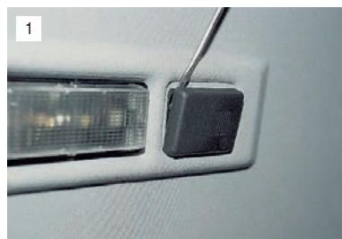
Поддеваем отверткой корпус датчика температуры.
