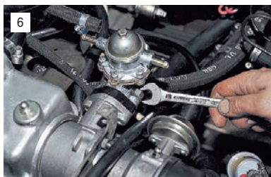
6 Ключом "на 13" отворачиваем две гайки крепления насоса к корпусу вспомогательных агрегатов.
