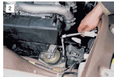
...ключом "на 13" отворачиваем два болта крепления подушки к кронштейну.
