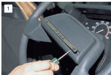
1 Поддеваем отверткой накладку крышки выключателя сигнала...
