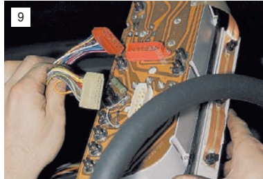
...и отсоединяем две колодки проводов.
