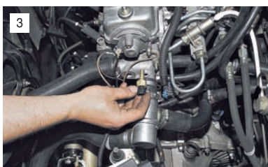
Снимаем датчик вместе с уплотнительным кольцом.
