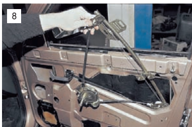
8 Вынимаем механизм стеклоподъемника через окно двери.
