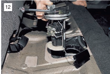
12 ...и, выводя поплавков из отверстия бака, снимаем электробензонасос с датчиком уровня топлива.
