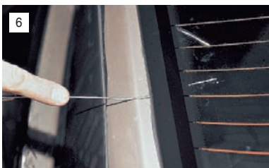
Для этого прокалываем клеевой шов стальной проволокой...
