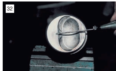
Расположение стрелки на поршне двигателей ВАЗ-2110, -2111...
