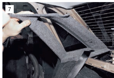
Поддев отверткой, снимаем накладку задних стоек.
