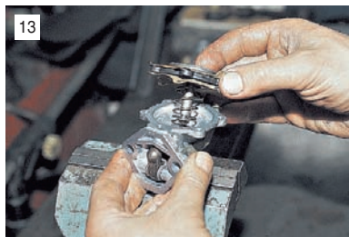
13 Вдавлив и повернув на 90° диафрагменный узел, вынимаем его.
