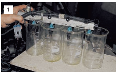
1 Расположив под форсунками мерные стаканы, проверяем двигатель стартером.
