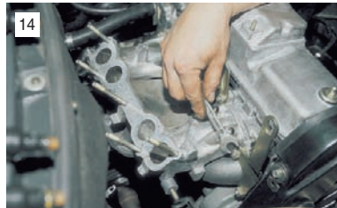
Ключом "на 13" отворачиваем две гайки крепления рыма.
