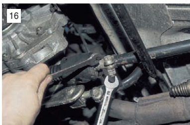
16 Снизу автомобиля двумя ключами "на 13" отворачиваем стяжной болт хомута тяги привода.
