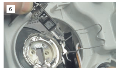
6 Потянув за вывод, вынимаем лампу из отверстия в отражателе.
