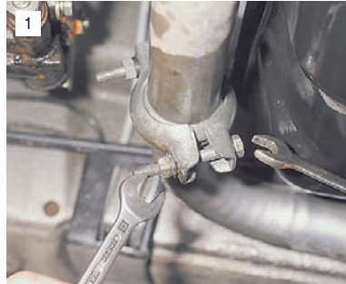
1 ...двумя ключами "на 13" отворачиваем гайку двух болтов крепления хомута.
