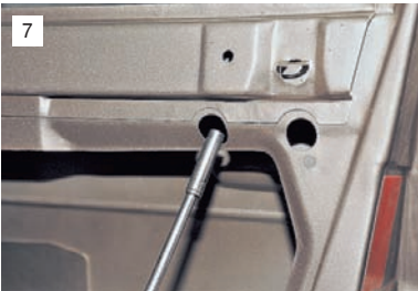
...головкой "на 8" отворачиваем две гайки...
