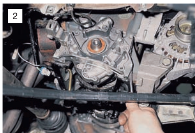
Поддеваем отверткой масляный насос...
