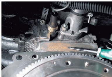
Номер двигателя выбит на блоке цилиндров над маховиком (для наглядности коробка передач снята).
