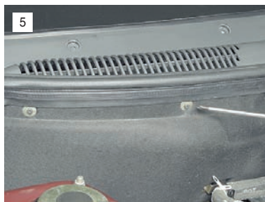
Крестообразной отверткой отворачиваем шесть саморезов крепления обивок моторного отсека к облицовке.
