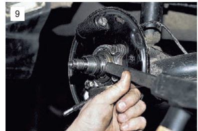
9 ...и зубилом стронуть кольцо с оси.
