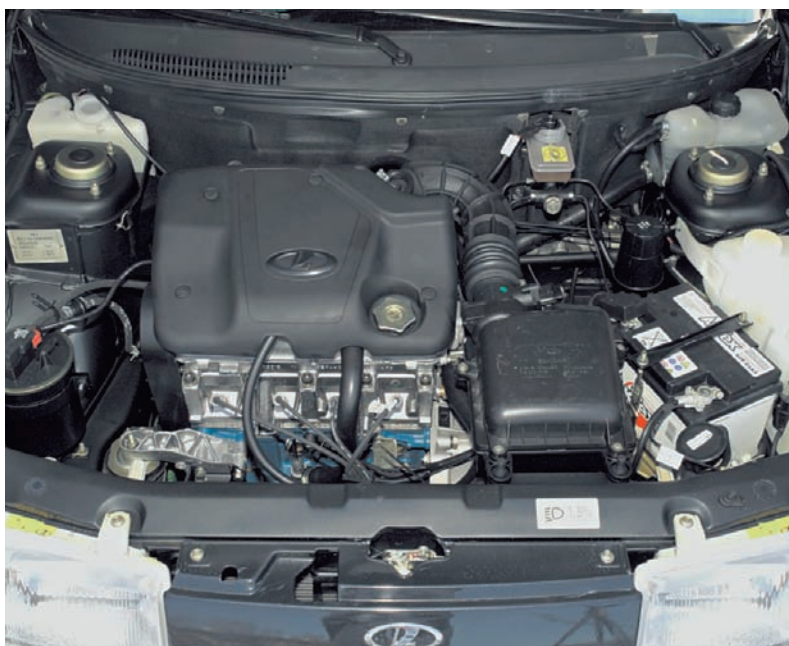
Моторный отсек автомобиля ВАЗ-21112 с восьмиклапанным двигателем рабочим объемом 1,6 л.
