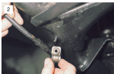
2 Снимаем скобу крепления троса.
