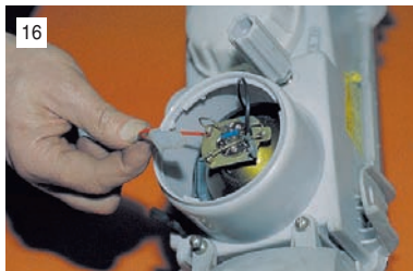
Отсоединяем провод от лампы ближнего света.
