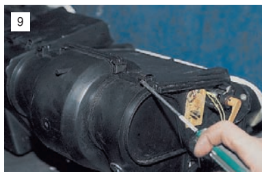
Отстегиваем четыре скобы верхнего крепления переднего кожуха отопителя,...
