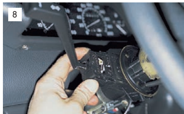
...и, сжав пальцами фиксаторы (сверху и снизу), снимаем подрулевой переключатель.
