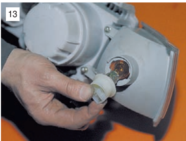
Повернув патрон указателя поворота против часовой стрелки, извлекаем его из гнезда вместе с лампой.
