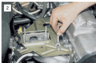
Отворачиваем ключом "на 10" две гайки крепления теплозащитного экрана...
