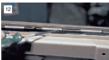
12 ...для чего отверткой выводим кромку уплотнителя из выступов проема.
