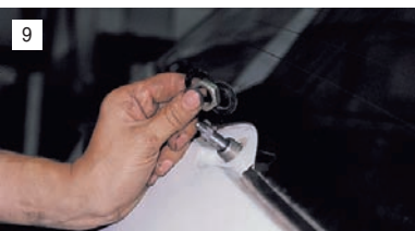
9 Под гайкой – пластмассовая шайба и резиновая втулка.
