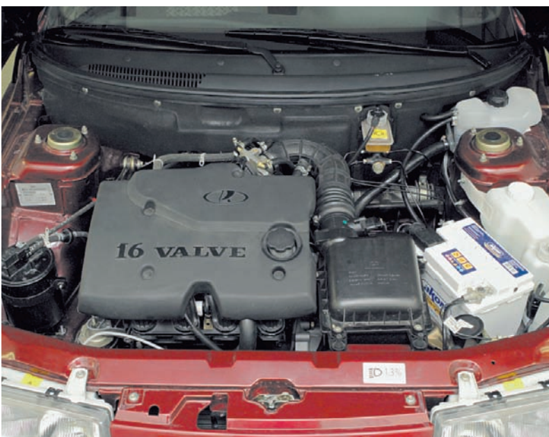
Моторный отсек автомобиля ВАЗ-21104 с шестнадцатиклапанным двигателем рабочим объемом 1,6 л.
