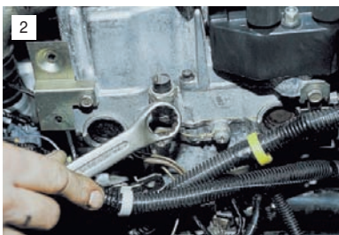
2 Ключом "на 21" отворачиваем датчик.
