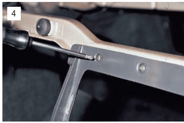
4 Крестообразной отверткой отворачиваем три самореза крепления рамки подлокотника к кузову.
