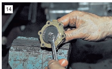
14 Ключом "на 8" отворачиваем гайку крепления штока.
