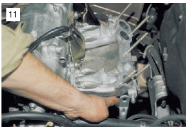
Отводим кронштейн от впускного коллектора.
