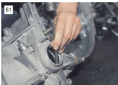
61 Через бородок наносим удары в торец наружного кольца подшипника дифференциала...
