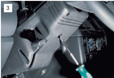
Отворачиваем саморез крепления нижнего кожуха к подрулевому переключателю...
