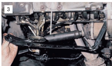
Стык уплотнен прокладкой.
