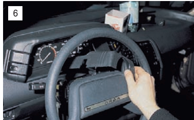
Опустив рулевую колонку вниз, снимаем верхний кожух.
