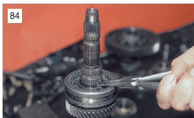
84 Круглогубцами разводим стопорное кольцо ступицы синхронизатора...
