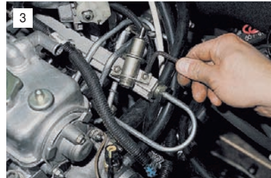
3 Шестигранником "на 5" отворачиваем два винта крепления регулятора к топливной рампе.
