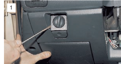
Поддев отверткой, снимаем рукоятку и накладку цилиндра гидрокорректора.
