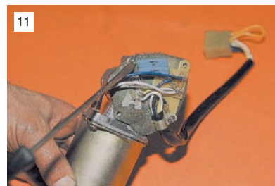
Отвернув крестообразной отверткой четыре винта крепления крышки моторедуктора,...
