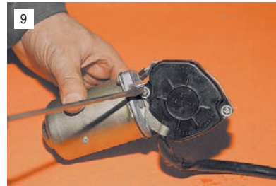
Крестообразной отверткой отворачиваем два винта крепления защитного колпака.
