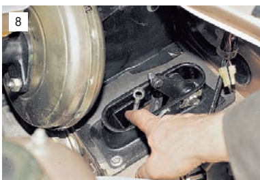
Снимаем верхний наконечник троса с пальца педали сцепления.
