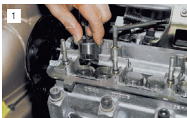
Вынимаем толкатель с регулировочной шайбой из гнезда головки блока цилиндров.
