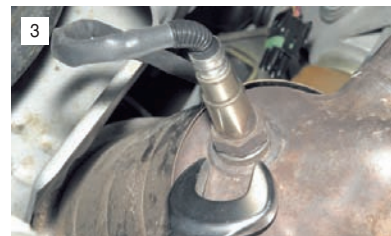
3 Ключом "на 22" отворачиваем датчик кислорода...
