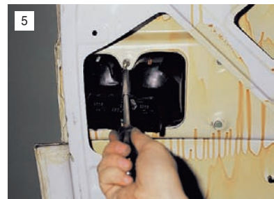
Головкой "на 8" отворачиваем две гайки...
