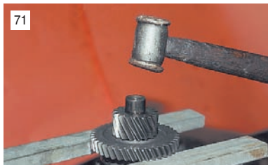
71 При отсутствии съемника подкладываем под шестерню упоры и наносим удары медным молотком в торец вала.
