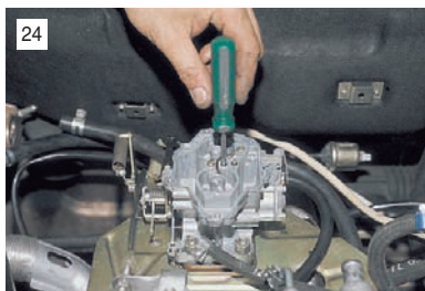
Шлицевой отверткой с узким лезвием (проходящей в эмульсионный колодец) выкручиваем главные топливные жиклеры.
