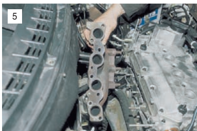
Снимаем со шпилек головки выпускной коллектор...
