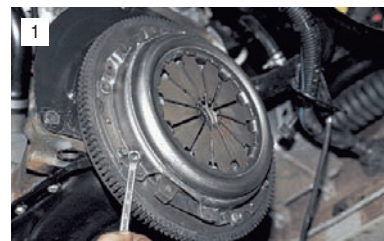
Накидным ключом "на 8" отворачиваем шесть болтов крепления кожуха сцепления к маховику.
