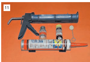
Для вклейки стекла необходим набор, включающий тубу с клеем, обезжириватель и грунт (праймер), а также "пистолет" - для выдавливания клея из тубы.
