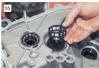
55 Вынимаем сепаратор подшипника.
