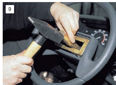
9 Если рулевое колесо сидит очень плотно, помощник тянет рулевое колесо вверх, а по торцу рулевого вала наносим удары через выколотку из мягкого металла.
