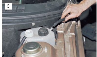
3 ...и пароводящий шланг радиатора отопителя.
