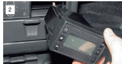
...и вынимаем маршрутный компьютер из посадочного места...
