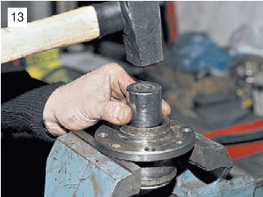
13 Через отрезок подходящей трубы выбиваем подшипник, опираясь на внутреннее кольцо...
