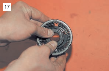
17 Сдвигаем ступицу внутри скользящей муфты синхронизатора...
