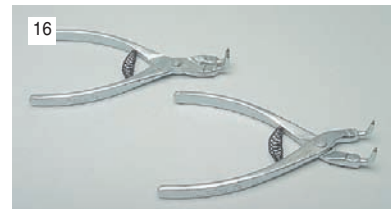
16 Щипцы для сжатия и разжатия стопорных колец.
