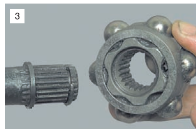
...снимаем обойму с сепаратором и шариками.
