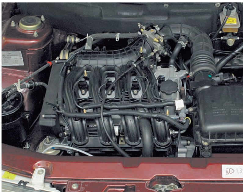
Двигатель ВАЗ-21124 со снятой крышкой.
