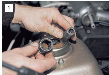
1 Снимаем (для обоих вариантов) резиновую заглушку верхней опоры и специальным ключом, позволяющим удерживать шток при отворачивании гайки,...
