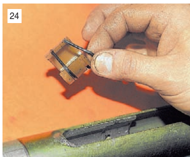
Перед установкой в картер новой опорной втулки надеваем на нее новые демпфирующие кольца так, чтобы тонкая их часть находилась против разреза втулки.
