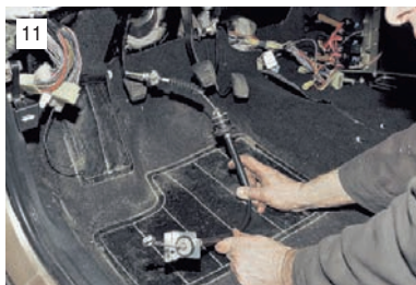
Вынимаем трос сцепления в салон через отверстие в щите передка кузова.
