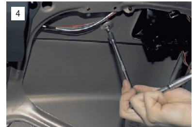
4 ...отворачиваем головкой "на 8" две крайних...
