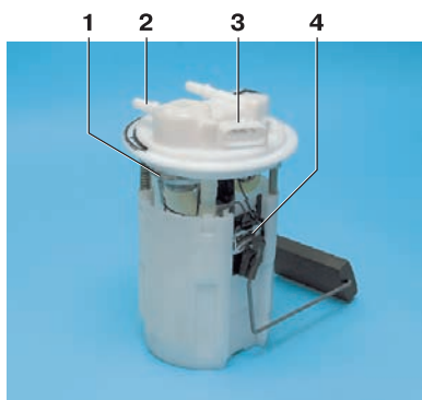
Модуль топливного насоса в сборе: 1 – встроенный регулятор давления топлива; 2 – штуцеры под установку топливопроводов с быстросъемными наконечниками; 3 – электрический разъем; 4 – датчик указателя уровня топлива.
