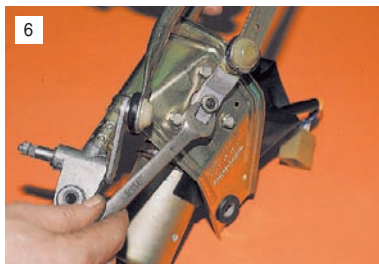
Ключом "на 13" отворачиваем гайку крепления кривошипа.
