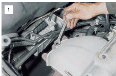
Ключом "на 13" отворачиваем три гайки крепления теплозащитного экрана...
