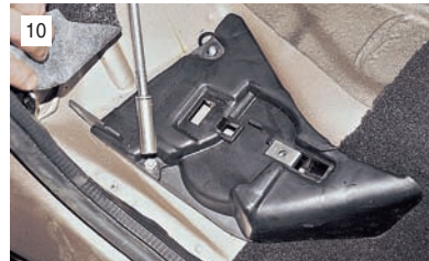
10 Головкой "на 10" отворачиваем две гайки крепления и снимаем основание.
