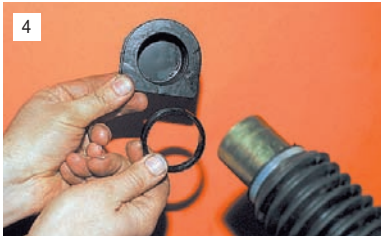
Снимаем опору и распорное кольцо с правой стороны картера рулевого механизма.
