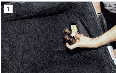
1 Открываем крышку в обивке багажника (она на "липучке") и, нажав на два фиксатора, вынимаем плату с лампами.
