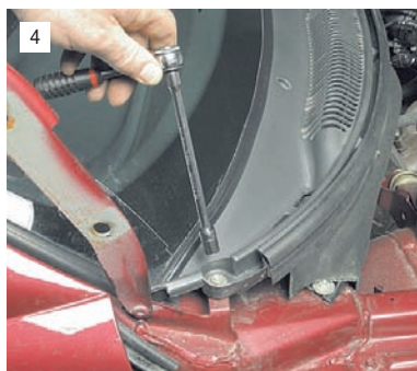
Головкой "на 10" отворачиваем две гайки по краям облицовки (капот автомобиля для наглядности снят).
