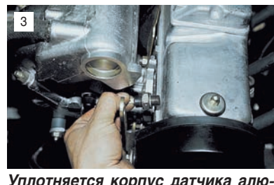
3 Уплотняется корпус датчика алюминиевым кольцом.
