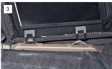
3 Выводим крюки спинки из скоб кузова и снимаем ее.
