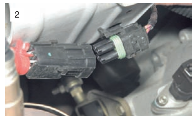
2 Отсоединяем колодку проводов датчика от жгута проводов системы управления двигателем.
