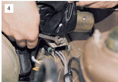
...а также один болт крепления кронштейна моторедуктора.
