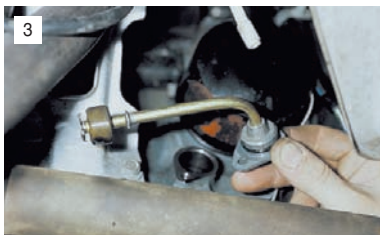
3 Слегка покачивая, выводим датчик из гнезда в блоке цилиндров, стараясь не повредить поплавок.
