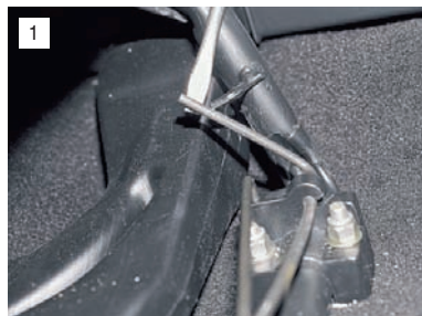
Отодвигаем сиденье назад до упора и отверткой отсоединяем торсионы от стойки основания подушки.
