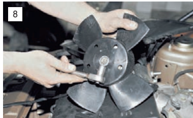
Головкой "на 13" отворачиваем гайку...
