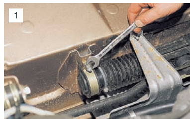
1 В моторном отсеке ключом "на 13" отворачиваем гайки крепления скоб рулевого механизма к передку кузова с правой...
