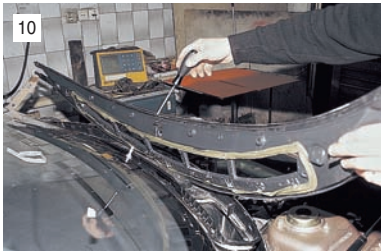
Поддеваем фиксатор в центре и снимаем накладку рамы ветрового окна.
