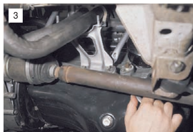
Ключом "на 13" отворачиваем два болта кронштейна крепления приемной трубы...
