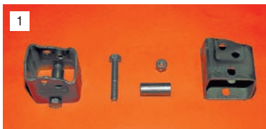
1 Выбираем проставки приемлемой высоты, позволяющие поднять задок в два положения – на 40 или 55 мм.
