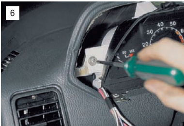
Крестообразной отверткой отворачиваем два винта крепления комбинации приборов к панели.
