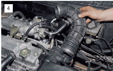
Снимаем воздушный шланг в сборе со шлангом вентиляции картера.
