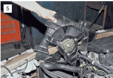
Вынимаем электровентилятор в сборе с кожухом.
