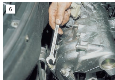
6 ...и пять гаек крепления к впускному коллектору.
