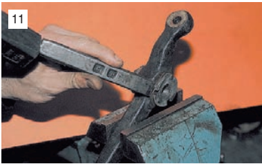
11 Сайлент-блок растяжки сбиваем зубилом.
