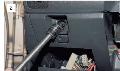
Головкой "на 22" отворачиваем гайку...
