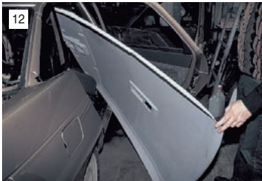
Опустив спинки передних сидений, вынимаем обивку через заднюю дверь.
