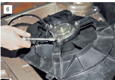
Ключом "на 10" отворачиваем три гайки крепления электродвигателя к кожуху.
