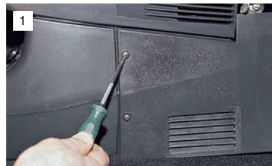
1 Отворачиваем два самореза крепления правого щитка облицовки тоннеля пола.
