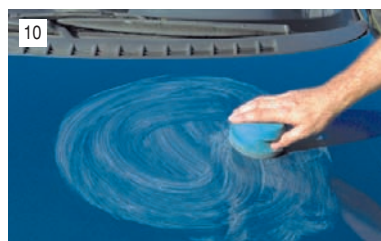
10 ...и наносим его ровным тонким слоем на часть детали.
