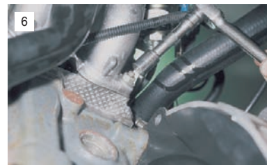
Чтобы снять впускной коллектор, головкой "на 13" отворачиваем пять гаек его крепления к головке цилиндров.
