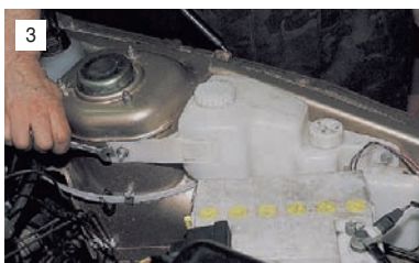
Для снятия бачка стеклоомывателя ключом "на 10" отворачиваем гайку заднего...
