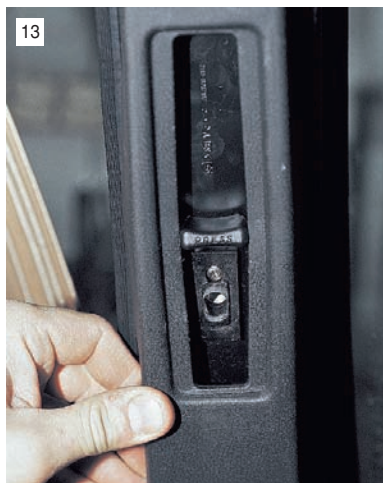
Сдвигаем накладку немного вниз, разжимаем паз и снимаем накладку с верхнего крепления ремня безопасности.
