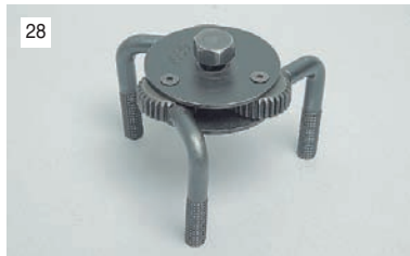
28 Съемник масляного фильтра.
