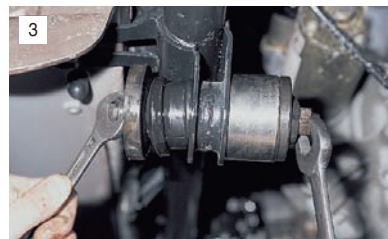
3 Запрессовку производим болтом с шайбами и отрезками труб.
