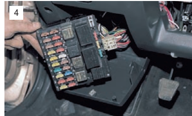
Вынимаем блок из крышки и переворачиваем его.
