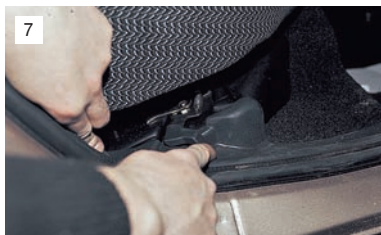
7 Нажимаем на защелки с двух сторон подушки заднего сиденья и снимаем ее.
