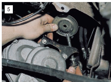
5 Снимаем нижний ограничитель подушки и вынимаем шпильку с лысками, исключая ее проворачивание в кронштейне коробки передач.
