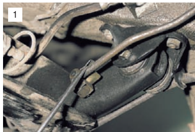
Отверткой приподнимаем вверх скобу серьги рычага привода регулятора.
