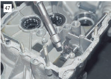
47 Головкой "на 10" отворачиваем установочный болт рычага выбора передач.
