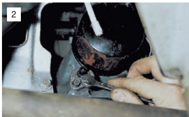
2 Ключом "на 10" отворачиваем болт крепления датчика.
