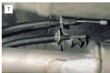
7 Вынимаем наконечник оболочки троса из кронштейна.
