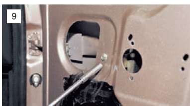
9 Головкой "на 8" отворачиваем болт крепления передней направляющей стекла...
