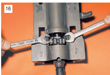
16 ...двумя ключами "на 13" отворачиваем гайку болта, вынимаем болт...
