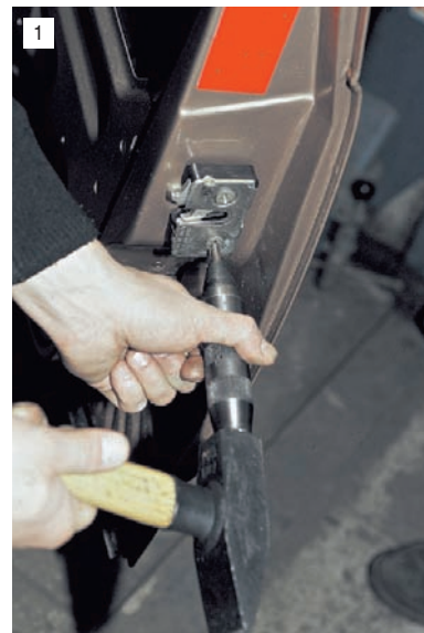
1 Ударной отверткой с крестообразным наконечником № 3 ослабляем два винта крепления замка.
