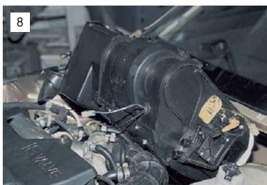
Извлекаем отопитель из моторного отсека.
