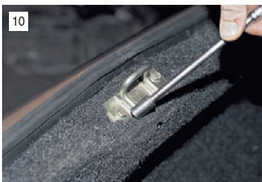
10 Для снятия фиксатора отворачиваем головкой "на 10" два болта...
