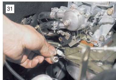
...и выводим конец троса из гнезда на рычаге.
