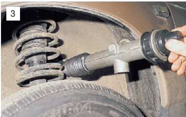
Сдвигаем вперед рулевой механизм до выхода шлицевого конца шестерни из отверстия передка кузова и вынимаем его через отверстие в брызговике.
