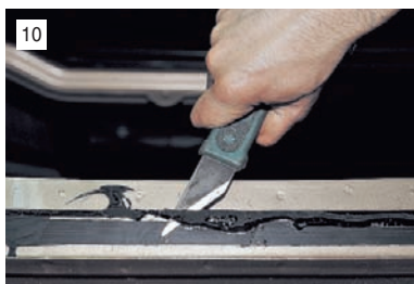
Срезаем старый клеевой шов острым ножом, оставляя слой толщиной 1-2 мм.
