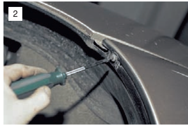
...и два самореза верхнего крепления подкрылков.
