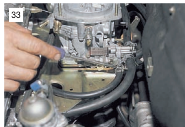
Крестообразной отверткой ослабляем хомут тонкого шланга вентиляции картера и снимаем шланг со штуцера.
