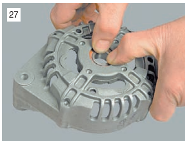
Руками выталкиваем подшипник из гнезда...
