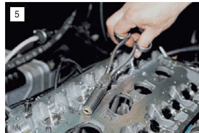
...снимаем маслоотражательный колпачок с направляющей втулки клапана.
