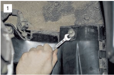
Ключом "на 10" отворачиваем два самореза крепления щитка к лонжерону.
