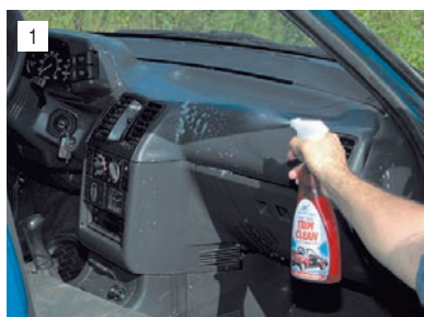
Наносим очиститель на пластиковые панели...
