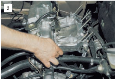
Ключом "на 17" отворачиваем гайку крепления левого кронштейна впускного коллектора...
