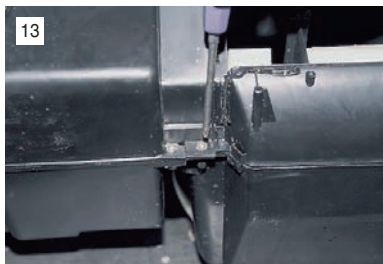
...и отворачиваем четыре самореза крепления переднего корпуса воздухозаборника отопителя.
