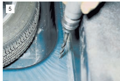
Накерниваем центр отверстия в полу багажника – примерно там, где указано на фото – для выхода пучка проводов. Тем же сверлом делаем это отверстие.
