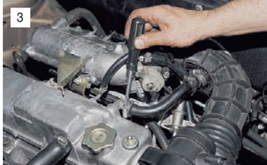
...и хомут крепления шланга вентиляции картерных газов (2-го контура) к патрубку крышки головки цилиндров.
