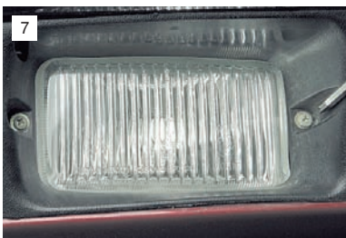
Крестообразной отверткой отворачиваем два самореза крепления облицовки противотуманной фары к кузову...
