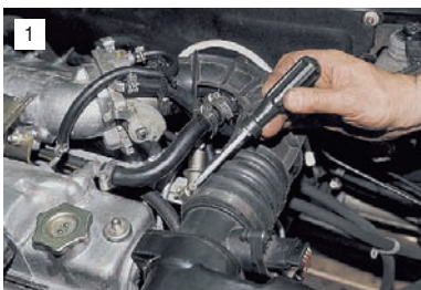
Ослабляем хомут и снимаем воздушный шланг с корпуса датчика массового расхода воздуха.
