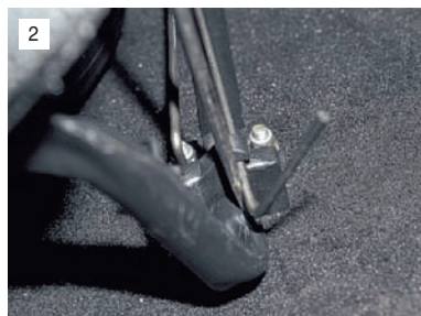
Выводим торсионы из пазов кронштейнов...
