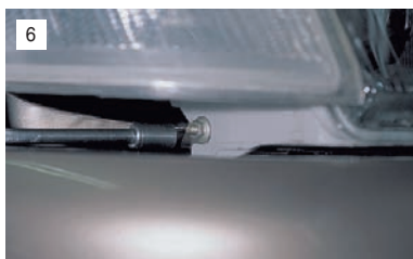
Головкой "на 10" отворачиваем гайку крепления блок-фары к кронштейну.
