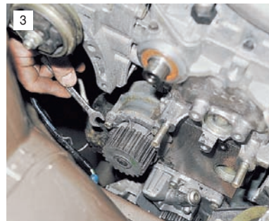
Ключом "на 10" отворачиваем три болта крепления насоса охлаждающей жидкости к блоку цилиндров.
