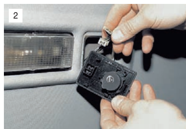
Отсоединив от датчика два разъема, снимаем его.
