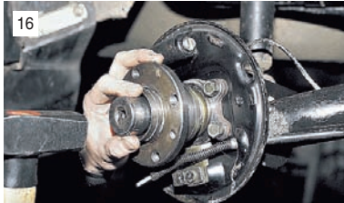
16 Осторожно, легкими ударами по внутреннему кольцу напрессовываем подшипник на ось ступицы до глубины, позволяющей наживить гайку.
