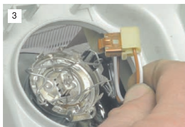
3 Снимаем колодку проводов с вывода лампы.
