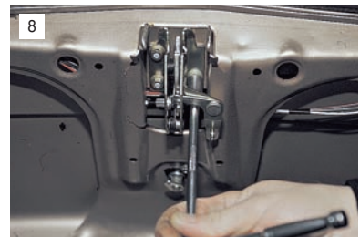
8 Головкой "на 10" отворачиваем три гайки крепления замка к крышке багажника...
