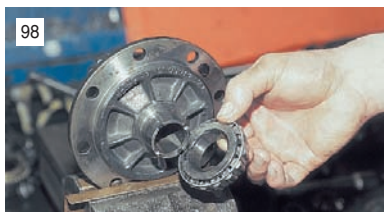
98 ...и спрессовываем подшипник.
