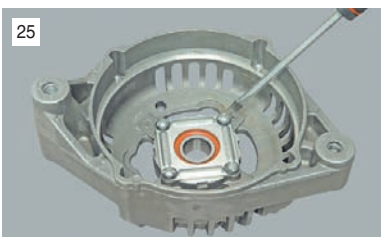
...шлицевой отверткой отворачиваем четыре винта крепления прижимной пластины подшипника.
