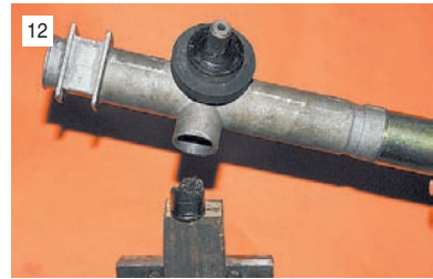
Ударом картера о деревянную подставку выбиваем упор рейки из гнезда. В кольцевой проточке упора установлено резиновое уплотнительное кольцо.
