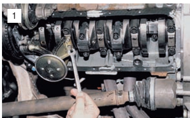
Ключом "на 10" отворачиваем два болта крепления маслоприемника ко второй коренной крышке...
