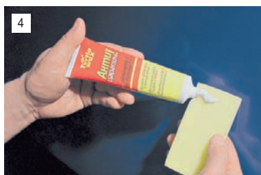
4 На влажный аппликатор выдавливаем пасту...
