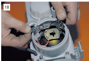
Отводим фиксатор вверх и вынимаем лампу ближнего света.
