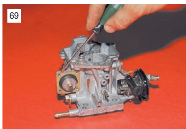
69 Аккуратно подцепив шлицевой отверткой или ножом диафрагму,...
