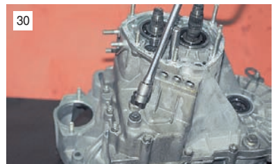
30 Головкой "на 13" отворачиваем пробку фиксатора задней передачи и вынимаем пружину.
