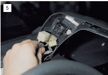
...и отсоединяем разъемы выключателей заднего противотуманного света и обогрева заднего стекла.
