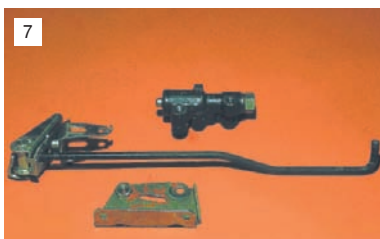
Отсоединяем от регулятора давления кронштейн и рычаги привода.
