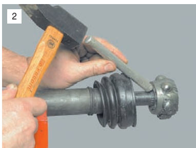
Нанося удары в торец обоймы шарнира через выколотку из мягкого металла...
