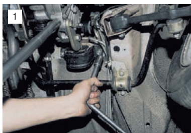
1 Головкой «на 17» отворачиваем две гайки крепления задней опоры к кузову.
