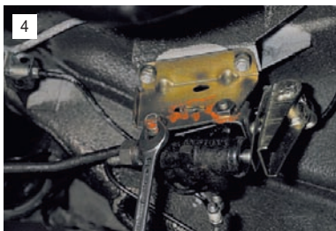
Ключом "на 13" отворачиваем два болта крепления корпуса регулятора к кронштейну.
