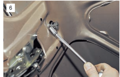
6 Головкой "на 8" отворачиваем болт крепления привода замка...
