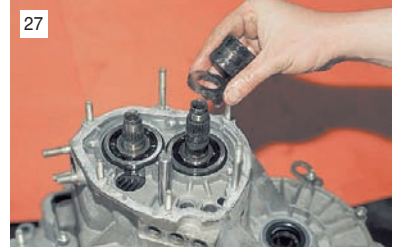
27 ...и спрессовываем втулку шестерни и упорную шайбу.
