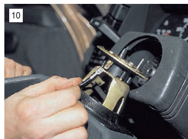
10 При необходимости замены контактного кольца рулевого колеса отсоединяем провод...
