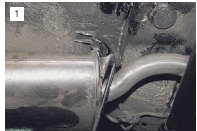
1 Отверткой отсоединяем от крюка переднюю...
