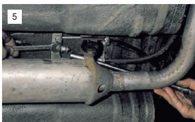
5 Ключом и высокой головкой "на 13" отворачиваем контргайку и регулировочную гайку тяги.
