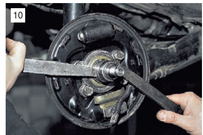
10 Дальше сдвигаем кольцо двумя монтажными лопатками.
