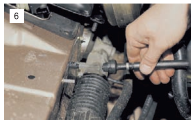
6 Вынимаем трос из щита передка.
