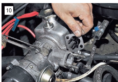
10 Снимаем еще одну уплотнительную прокладку.
