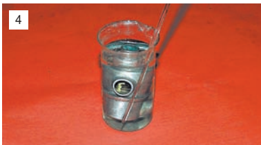
4 Для проверки термостата опускаем его в сосуд с охлаждающей жидкостью, подогреваем сосуд и контролируем по термометру начало открытия основного клапана.
