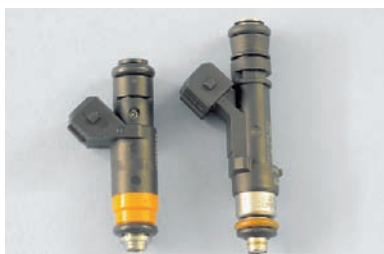
Форсунки двигателей ВАЗ-21124 (слева) и ВАЗ-21114 (справа).
