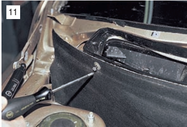
Крестообразной отверткой отворачиваем шесть саморезов крепления обивки моторного отсека к кожуху.
