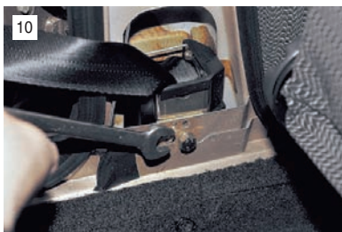
Ключом "на 17" отворачиваем болт крепления катушки ремня безопасности к кузову...
