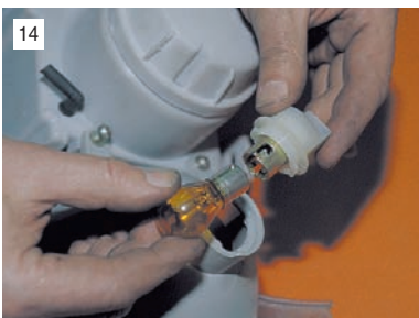
Вдавлив лампу внутрь и повернув против часовой стрелки, вынимаем ее из патрона.
