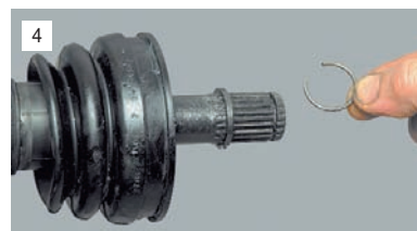
...вынимаем стопорное кольцо из проточки вала.
