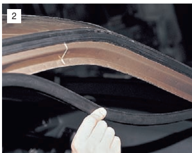
Снимаем уплотнитель с дверных проемов.
