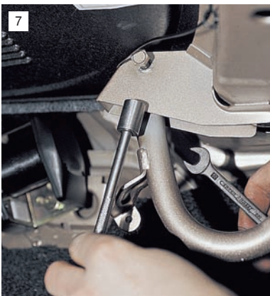
7 Ключом "на 10" отворачиваем гайки, удерживая болты петель головкой "на 13".
