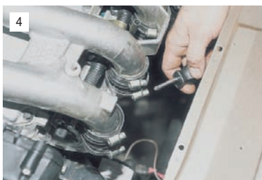
Крестообразной отверткой ослабляем хомуты крепления муфт, соединяющих ресивер с впускным коллектором.
