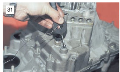
31 Вставляем в гнездо фиксатора отвертку и, приложив к ней магнит, извлекаем шарик.
