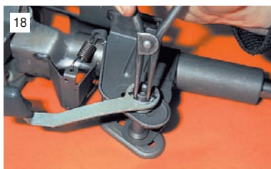
18 Для регулировки усилия затяжки фиксатора рулевой колонки щипцами разводим стопорное кольцо...
