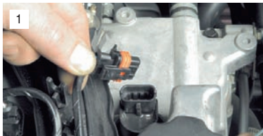
1 Отсоединяем колодку проводов от катушки зажигания.
