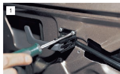
1 Крестообразной отверткой отворачиваем три винта крепления внутренней ручки к двери...
