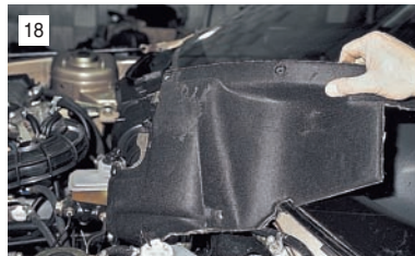
Отсоединяем хомут крепления шлангов к обивке моторного отсека.
