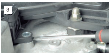
3 Поддеваем фланец катушки отверткой...
