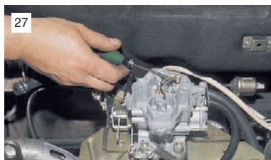
Шлицевой отверткой поддеваем распылительные трубки ускорительного насоса и вынимаем их.
