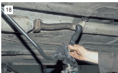
18 ...и выводим тягу привода с рычагом переключения передач.
