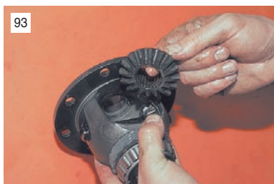
93 Проворачивая, вынимаем шестерни приводов (полуосевые) из коробки.
