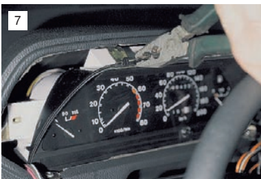
Пассатижами отгибаем крепежные усики комбинации приборов.
