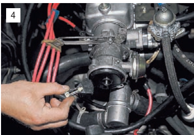
4 Потянув, снимаем бегунок.
