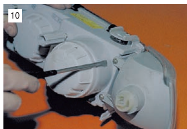
Отворачиваем два винта крепления указателя поворота...
