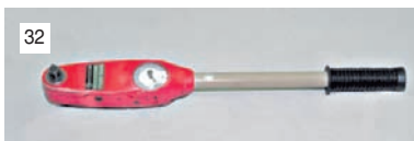
32 Динамометрический ключ (до 25 кгс·м).
