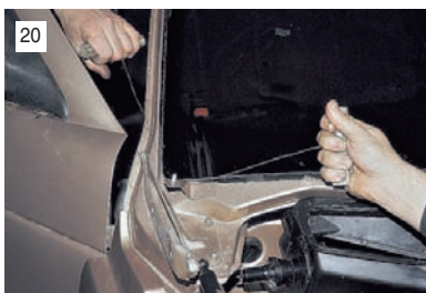
20 Вырезать ветровое стекло удобнее с нижнего угла, расположив сначала оба держателя струны снаружи.
