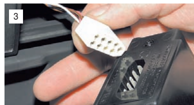
...и отсоединяем от него колодку проводов.
