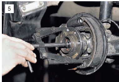
5 Снимаем ступицу универсальным двух- или трехлапым съемником.
