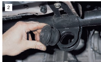
2 Очищаем гнездо от грязи и продуктов коррозии и обильно смазываем его и новый сайлент-блок мыльным раствором.
