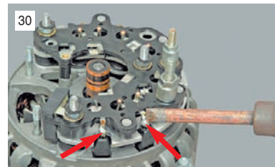
...отпаиваем шесть выводов обмотки статора от выводов выпрямительного блока...
