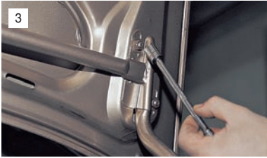
3 Головкой "на 13" отворачиваем четыре гайки крепления крышки багажника к петлям...
