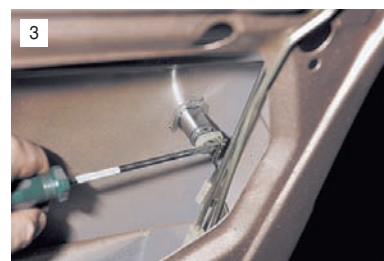
3 Отверткой отсоединяем тягу от выключателя замка...
