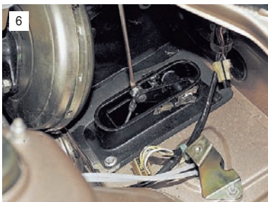
Отверткой поддеваем стопорную скобу пальца педали сцепления...
