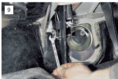
В салоне ключом "на 8" отворачиваем болт крепления упорной пластины верхнего наконечника оболочки троса.
