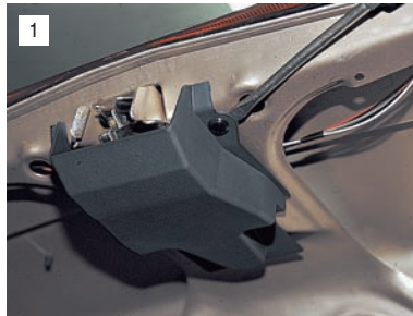
1 Поддеваем отверткой четыре пистона крепления кожуха замка...
