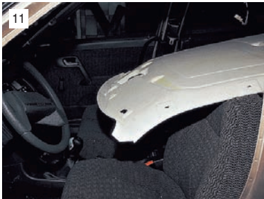
Выводим обивку из-под верхних накладок центральных стоек и снимаем обивку.
