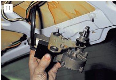
11 ...и, отсоединив электроразъем, снимаем моторедуктор очистителя заднего стекла.
