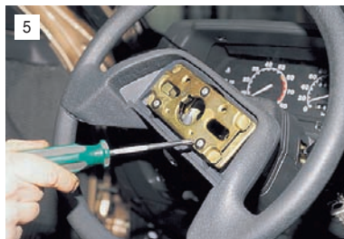
5 Крестообразной отверткой отворачиваем три самореза подвижного контакта звукового сигнала...
