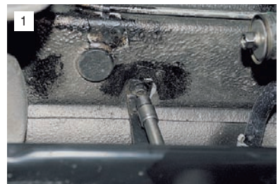
1 Головкой "на 13" отворачиваем два болта прижимных лент.
