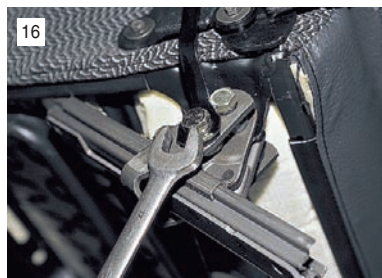
Для снятия замка ремня безопасности ключом "на 17" отворачиваем болт от скобы салазок сиденья.
