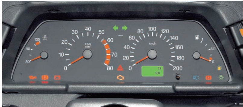
Комбинация приборов с жидкокристаллическим дисплеем индикации общего и суточного пробега.
