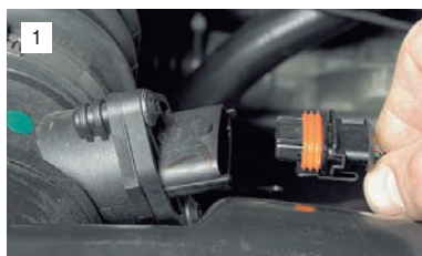
Отсоединяем колодку проводов датчика массового расхода воздуха.
