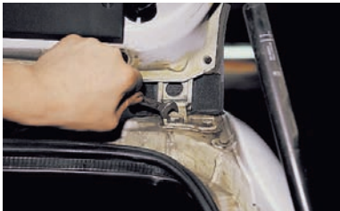
Ключом "на 10" отворачиваем по два болта крепления петель к кузову...
