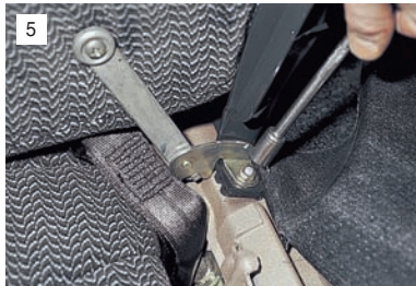
5 Головкой "на 10" отворачиваем две гайки крепления петли подлокотника к кузову...
