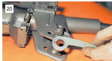
20 Снимаем рычаг фиксатора со шлицев и переставляем его в необходимое положение.
