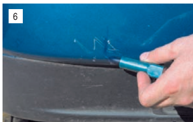
6 Мягко нажимая, заполняем карандашом сколы и царапины – карандаш должен двигаться поперек их направления.
