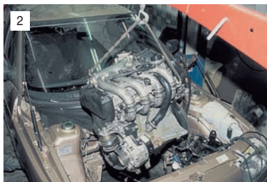
2 Отсоединив переднюю, заднюю и правую опору двигателя ВАЗ-2112, снимаем его.
