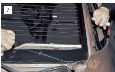
...или делаем струной пропил в нижнем углу стекла.
