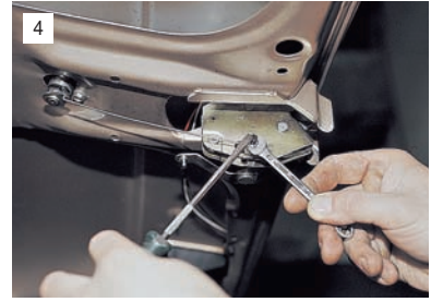
4 Отверткой ослабляем винт крепления тяги привода, удерживая бобышку ключом "на 7".
