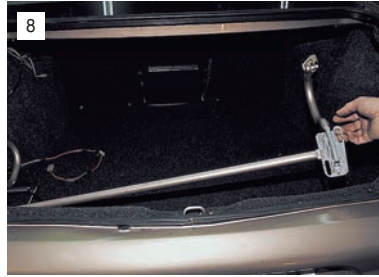
8 Вынимаем болты и снимаем петли.
