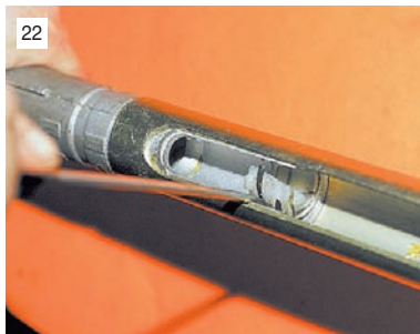
Поддев отверткой опорную втулку, выводим ее выступы из отверстий картера...
