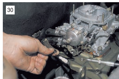
Отсоединяем возвратную пружину от рычага привода дроссельных заслонок...
