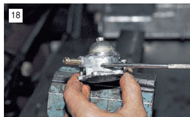
18 На верхней части корпуса насоса нанесена стрелка, указывающая направление потока топлива.
