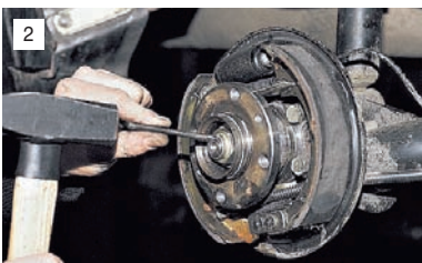
2 Узким зубилом выправляем замятый буртик гайки в двух местах.
