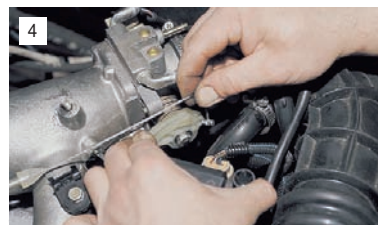
4 Выводим наконечник троса из сектора привода заслонки.
