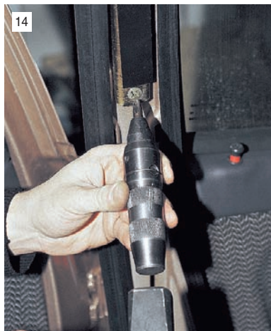
Ударной отверткой отворачиваем два винта крепления регулируемой по высоте верхней опоры ремня безопасности...
