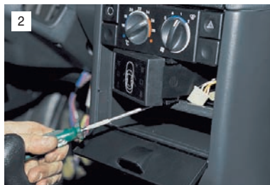
Снимаем блок индикации бортовой системы контроля...
