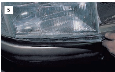
Сдвигаем накладку к центру автомобиля и вынимаем ее.
