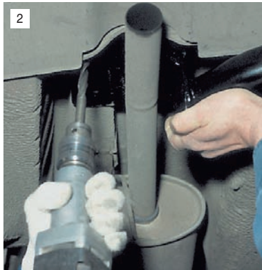
Сквозь отверстия кронштейнов сверлим два отверстия (слева и справа) диаметром 12,5–13,0 мм.
