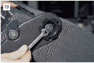
19 ...ключом "на 10" отворачиваем болт...
