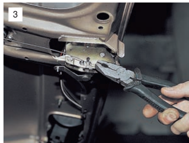
3 Пассатижами распрямляем конец тяги привода.
