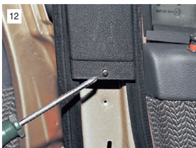
Крестообразной отверткой отворачиваем саморез нижнего крепления верхней накладки центральной стойки.
