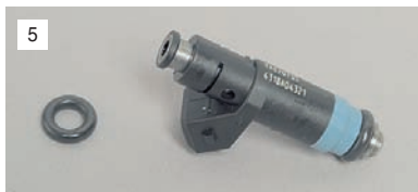
Посадочные места форсунки в рампе и головке блока цилиндров уплотняются резиновыми кольцами.
