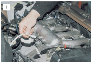
Отсоединяем от ресивера шланг подвода разрежения к электропневмоклапану...
