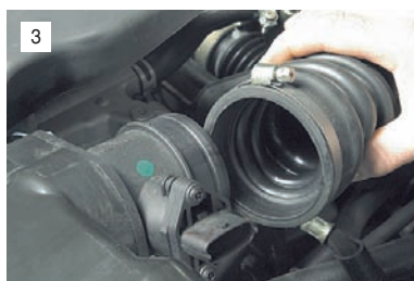
...и отсоединяем воздуховод от патрубка датчика массового расхода воздуха.
