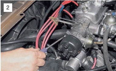
2 Крестообразной отверткой отворачиваем два винта крепления крышки...
