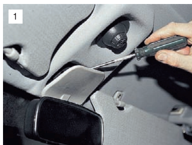
1 Поддев отверткой, снимаем декоративный щиток.
