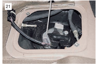
21 Устанавливаем узел бензонасоса в бак так, чтобы стрелка на фланце указывала на заднюю часть автомобиля.
