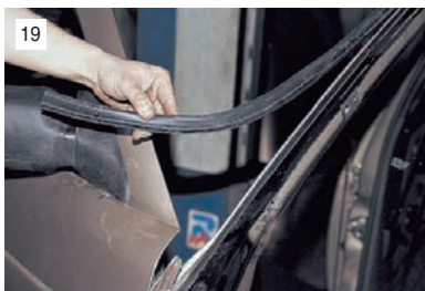
19 Снимаем наружные уплотнители передних дверей.
