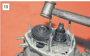
19 Медным молотком наносим удар в торец первичного вала.
