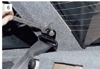
Ключом "на 17" отворачиваем болты крепления ремней к задним стойкам.
