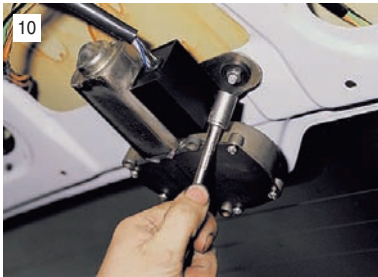
10 Головкой "на 10" отворачиваем две гайки...
