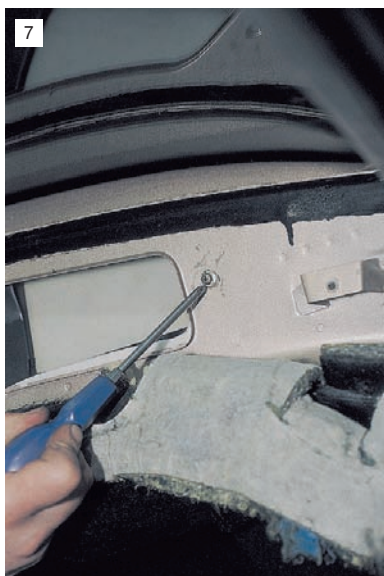
...с правой стороны - один саморез под шумоизоляцией.
