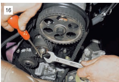
16 Вставив отвертку между двумя винтами или стержнями диаметром 4 мм, установленными в отверстие натяжного ролика, и поворачивая ролик против часовой стрелки, натягиваем ремень.
