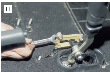
11 Ключом "на 10" отворачиваем две гайки верхнего крепления накладки кронштейна блокировки заднего хода...
