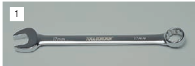
1 Ключ комбинированный (рожковый - накидной): 5; 6; 7; 8; 10; 11; 12; 13; 14; 15; 17; 19; 21; 22; 24; 30; 32.
