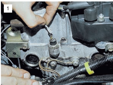
1 Снимаем клемму с датчика.
