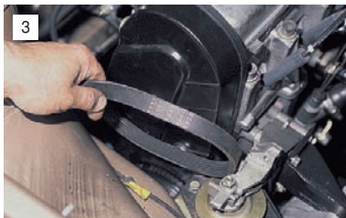
Сдвинув генератор к блоку цилиндров, снимаем ремень.
