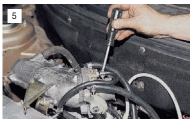
Крестообразной отверткой ослабляем хомут крепления и снимаем шланг вентиляции картера (1-го контура) со штуцера дроссельного узла.
