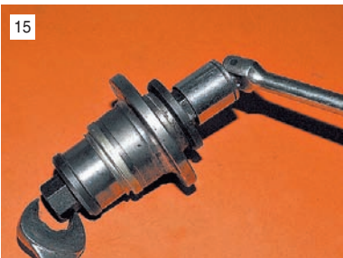
15 Новый подшипник в очищенную и смазанную ступицу запрессовываем съемником...
