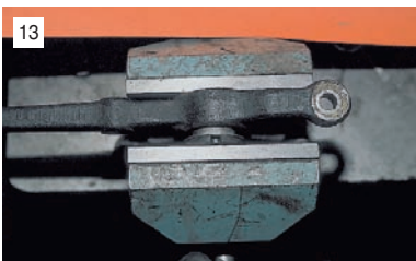
13 Новый сайлент-блок предварительно запрессовываем в тисках...
