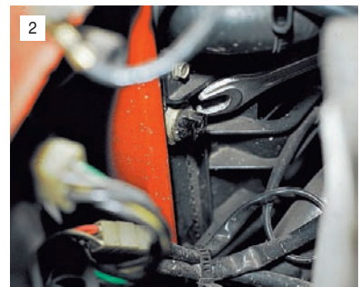
Ключом «на 30» отворачиваем датчик.
