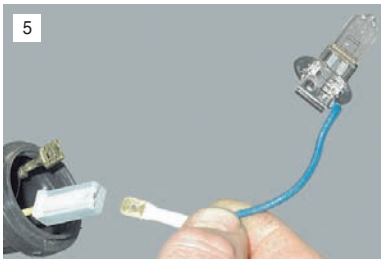
Отсоединяем от провода лампы наконечник "плюсового" провода.
