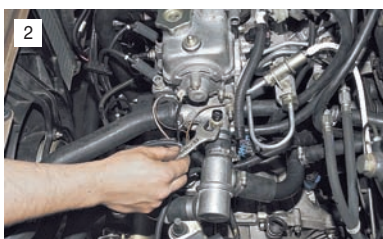
Ключом "на 19" отворачиваем датчик температуры охлаждающей жидкости.
