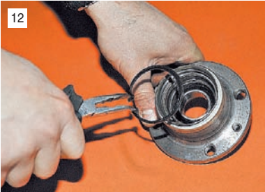
12 Щипцами снимаем стопорное кольцо.
