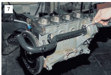
7 Ключом "на 10" отворачиваем два болта крепления подводящей трубы насоса охлаждающей жидкости...
