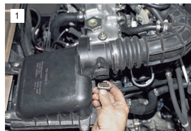
Выключив зажигание, отсоединяем электрический разъем датчика.
