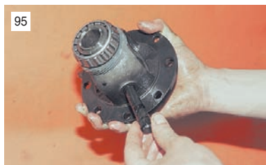
95 Надавив на ось сателлитов, вынимаем ее из коробки.
