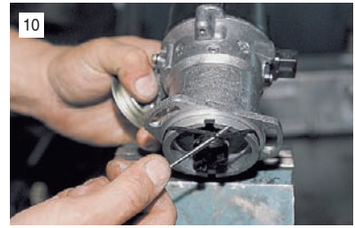
10 Датчик-распределитель уплотняется резиновым кольцом, которое снимаем, поддевая отверткой.
