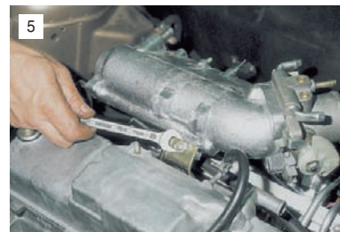
5 Ключом "на 13" отворачиваем гайку крепления ресивера к кронштейну...
