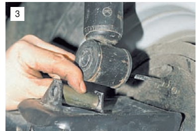
3 Между проушинами вставляем распорную втулку.
