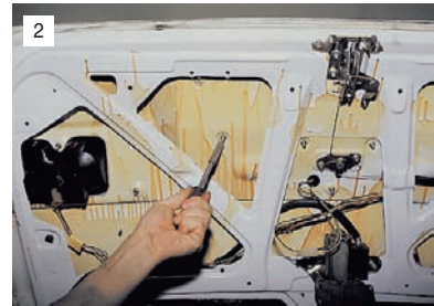
Головкой "на 8" отворачиваем девять гаек крепления накладки...
