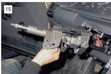
15 ...и снимаем рулевую колонку, стягивая вал со шлицев приводной шестерни.
