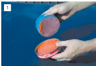
1 На влажный аппликатор наносим тонкоабразивный состав...
