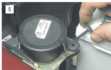
...и вынимаем стопорные штифты двух pistонов крепления козырька воздухозаборного шланга.
