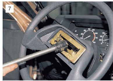
7 Головкой "на 24" отворачиваем гайку крепления рулевого колеса, но не до конца.
