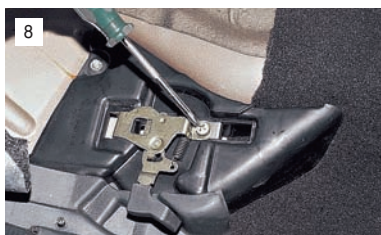
8 Крестообразной отверткой отворачиваем винт крепления замка подушки сиденья...
