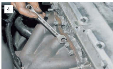
Ключом "на 13" отворачиваем восемь гаек крепления выпускного коллектора к головке цилиндров.
