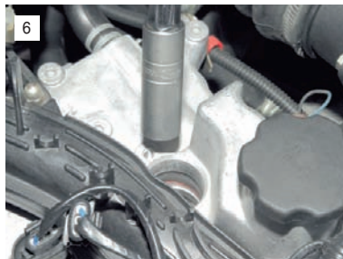
6 ...свечным ключом "на 16" или высокой головкой с удлинителем...
