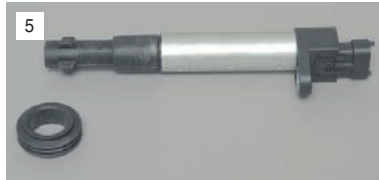
5 При необходимости снимаем и заменяем уплотнительное кольцо катушки.
