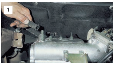
1 Отсоединяем от ресивера шланги вакуумного усилителя...
