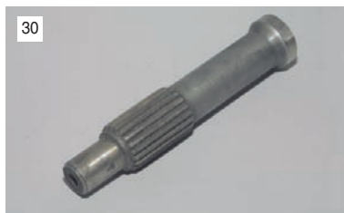
30 Оправка для центровки ведомого диска сцепления.
