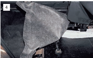
Снимаем коврик пола, под которым расположен формованный шумоизоляционный материал.
