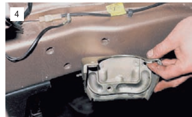
Снимаем кронштейн (для наглядности фото сделано при снятом двигателе).
