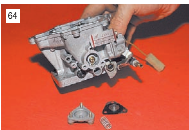
64 ...и, сняв крышку, вынимаем пружину и диафрагму.
