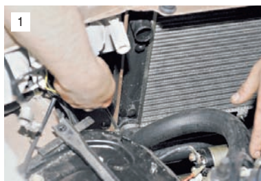
Ослабляем хомут и снимаем отводящий шланг радиатора.
