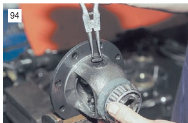
94 Зажав коробку дифференциала в тиски, круглогубцами снимаем стопное кольцо с оси сателлитов.
