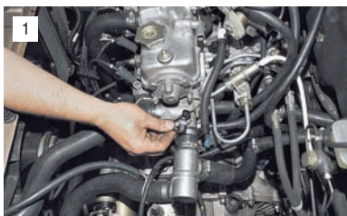
Выключив зажигание, отсоединяем разъем датчика.
