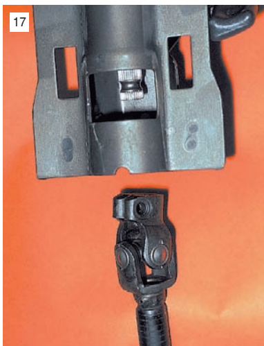
17 ...и сдвигаем вал со шлицев.
