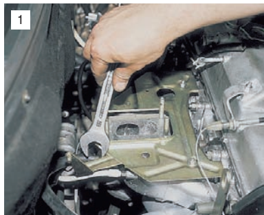
Ключом "на 22" отворачиваем гайку крепления теплозащитного экрана.
