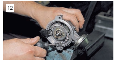
12 Отворачиваем два винта крепления держателя переднего подшипника...
