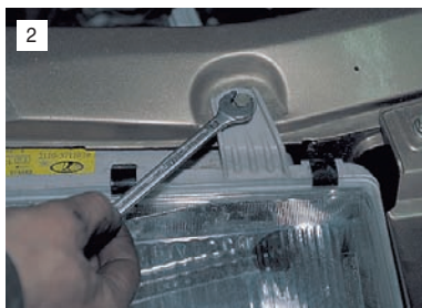
Ключом "на 10" отворачиваем два болта верхнего крепления блок-фары.
