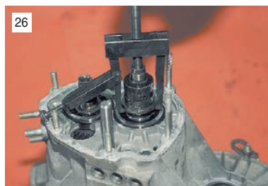
26 В образовавшийся зазор между торцом заднего подшипника и упорной шайбой вводим лапы съемника...
