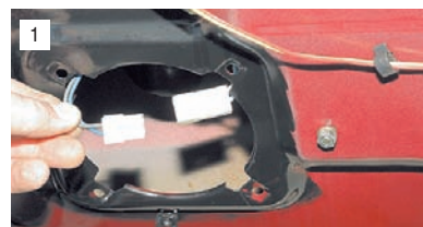
Отсоединяем колодку проводов питания электропривода стеклоподъемника от колодки жгута проводов.
