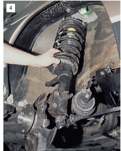
4 ...и снимаем амортизаторную стойку вместе с поворотным кулаком.
