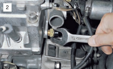
2 Ключом "на 21" отворачиваем датчик температуры...
