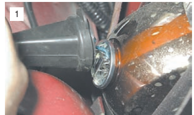
Снимаем с пояска на тыльной стороне отражателя резиновый защитный колпачок.
