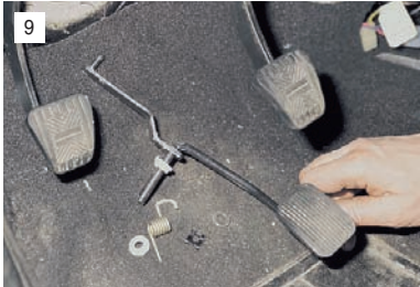
...и вынимаем рычаг (с педалью) привода дроссельной заслонки.
