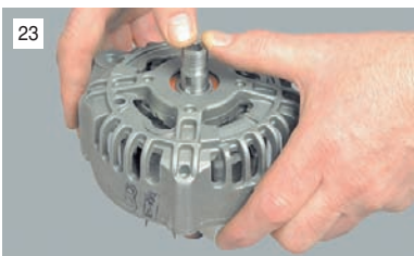
Выталкиваем вал ротора из передней крышки...
