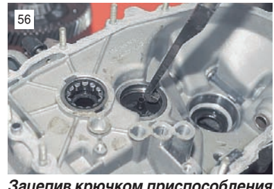
56 Зацепив крючком приспособления буртик наружного кольца подшипника, ударами по крючку...
