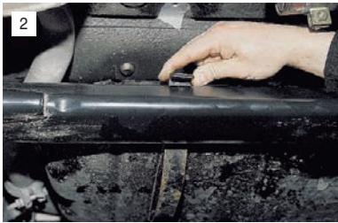
2 Зацепляем прижимные ленты за балку заднего моста и опускаем бак на них.
