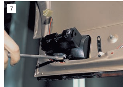
7 Головкой "на 8" отворачиваем две гайки крепления фонаря...
