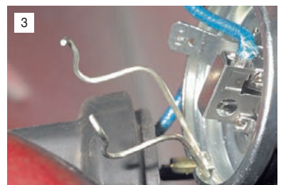
Сжимаем пальцами пружинную скобу крепления лампы и отводим скобу.
