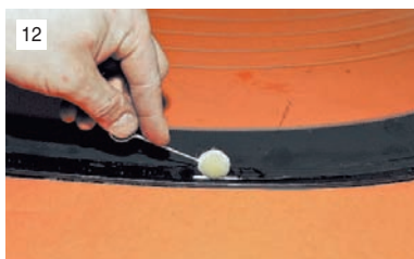
Обезжириваем по всему периметру край стекла в месте нанесения клея...
