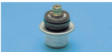
Регулятор давления топлива, устанавливаемый в модуль топливного насоса.
