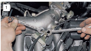
1 Двумя ключами "на 13" ослабляем гайки крепления оболочки троса привода заслонки к кронштейну.
