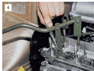
Сжимаем пружины и извлекаем пинцетом сухари.
