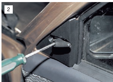
2 Крестообразной отверткой отворачиваем винт крепления ручки...
