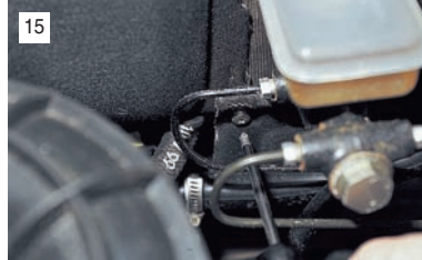
Поддеваем фиксатор в центре и снимаем накладку рамы ветрового окна.
