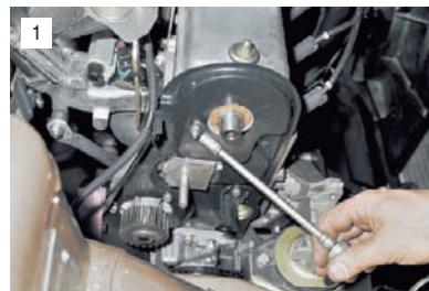
Головкой "на 10" отворачиваем гайку...
