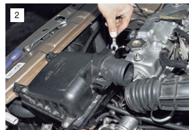
Отсоединив шланг впускной трубы, ключом "на 10" отворачиваем два болта крепления датчика к корпусу воздушного фильтра.
