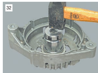
...запрессовываем подшипник в крышку подходящей инструментальной головкой, прикладывая усилие к наружному кольцу подшипника.
