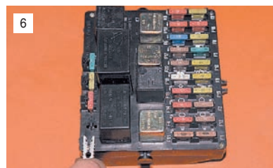
Для замены предохранителей вынимаем щипцы...
