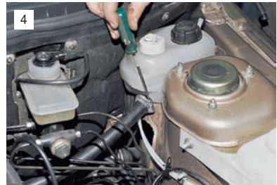
4 Ослабляем хомут заправочного шланга и снимаем шланг.
