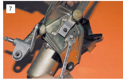
Ключом "на 10" отворачиваем три болта крепления моторедуктора к кронштейну...
