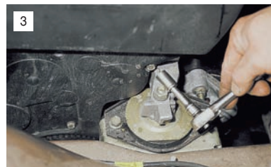
3 Головкой "на 10" отворачиваем шесть болтов крепления передней крышки...
