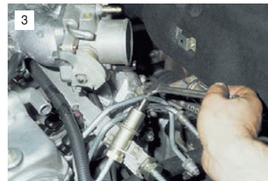
3 Ключом "на 13" отворачиваем две гайки крепления к ресиверу кронштейна топливных трубок.
