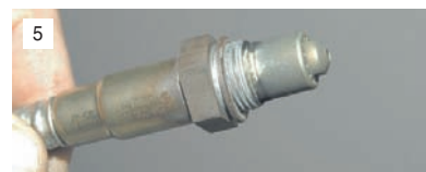
5 Датчик уплотняется металлическим кольцом.
