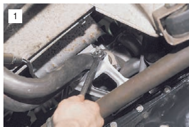
Ключом "на 13" отворачиваем две гайки хомута кронштейна крепления приемной трубы.
