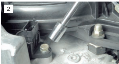
2 Головкой «на 10» отворачиваем болт крепления катушки.
