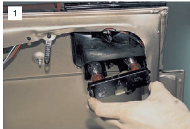
1 Сжав выступы, снимаем плату фонаря.
