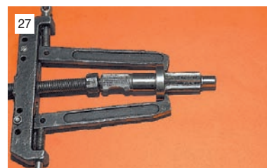
...и двухлапым съемником выпрессовываем шариковый подшипник.
