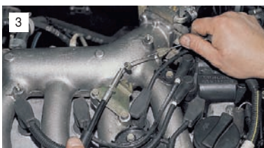
3 Выводим трос из прорези кронштейна.
