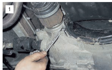
1 Ключом "на 10" отворачиваем три болта крепления нижней крышки картера сцепления...
