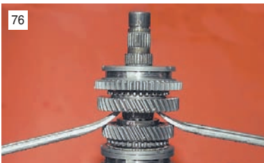
76 Поддев двумя монтажными лопатками ведомую шестерню II передачи, спрессовываем с вала ступицу скользящей муфты синхронизатора I-II передач.
