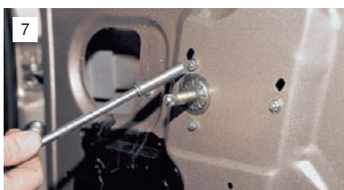
7 Головкой "на 8" отворачиваем три гайки крепления механизма стеклоподъемника.
