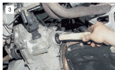
3 Снимаем правый привод передних колес (см. "Снятие приводов передних колес") и вместо него вставляем в отверстие коробки передач деревянную заглушку...
