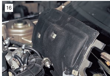
Крестообразной отверткой отворачиваем шесть саморезов крепления обивки моторного отсека к кожуху.
