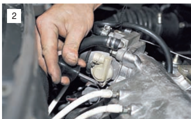
Крестообразной отверткой отворачиваем два винта крепления датчика к дроссельному узлу...
