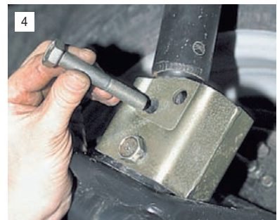
4 Вставляем болт крепления нижнего конца амортизатора и наживляем гайку.
