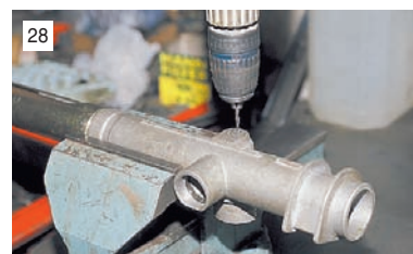
Если такового нет, сверлом диаметром 2 мм в торце картера делаем два отверстия так, чтобы они выходили на кольцо игольчатого подшипника.
