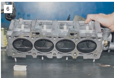
При разборке клапанного механизма подкладываем под тарелку рассухариваемого клапана упор (деревянный брусок).
