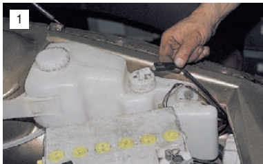
Отсоединяем разъем датчика уровня жидкости в бачке стеклоомывателя.
