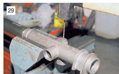
Через отверстия выбиваем подшипник из картера.
