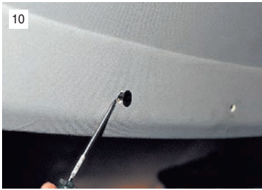
Отверткой извлекаем три держателя обивки.
