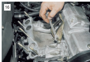
Ключом "на 13" отворачиваем три гайки крепления кронштейна ресивера...
