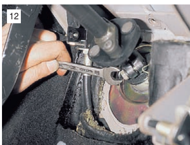
12 Ключом "на 13" отворачиваем болт нижнего фланца эластичной муфты (под педалями).
