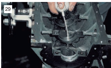
На двигателе ВАЗ-2112 перед установкой верхних вкладышей коренных подшипников аэрозольным очистителем карбюратора прочищаем форсунки для охлаждения поршней.
