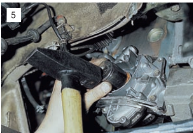
5 Смазываем рабочую кромку нового сальника моторным маслом и запрессовываем подходящим отрезком трубы.
