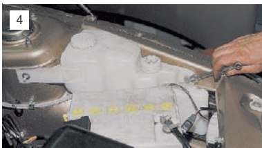
...и болт переднего крепления бачка к кузову.
