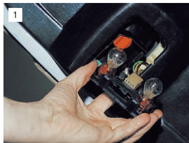
...и, сжав фиксаторы, вынимаем плату с лампами.
