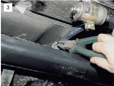
3 Ослабляем хомуты шланга вентиляции бака...
