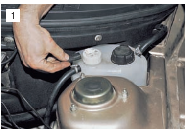
1 Отсоединяем разъем датчика уровня охлаждающей жидкости.
