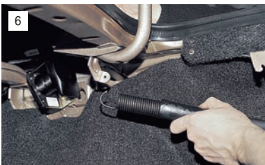
6 ...и передние концы пружин петель крышки багажника.
