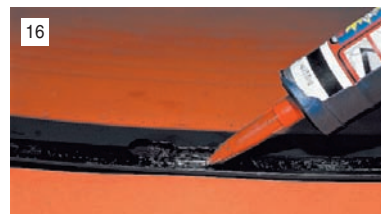
Выдавливая из тубы клей, наносим его ровным валиком высотой 10-12 мм по всему периметру стекла.
