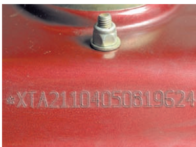
Идентификационный номер (VIN) автомобиля выбит на правой чашке опоры телескопической стойки...
