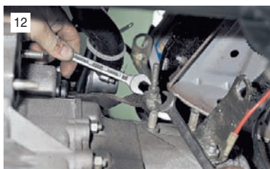
...двумя ключами "на 13" ослабляем контргайку нижнего наконечника троса.
