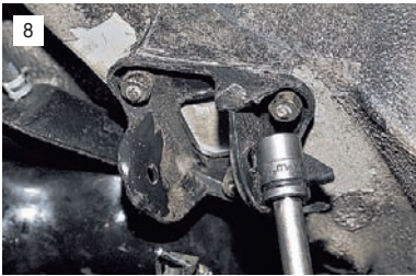
8 Головкой "на 17" отворачиваем три гайки крепления кронштейна к кузову...
