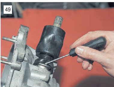
49 Поддев отверткой, снимаем защитный чехол штока со втулки.
