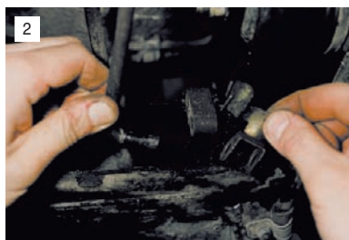
Выводим конец рычага из отверстия серьги и снимаем скобу.
