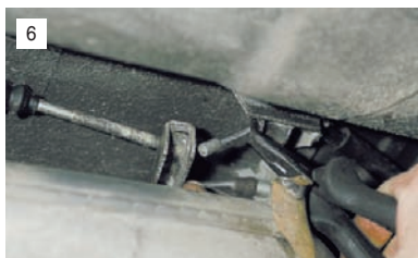
6 Выводим наконечник троса из прорези уравнивателя.
