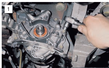
Головкой "на 10" отворачиваем шесть болтов крепления масляного насоса к блоку цилиндров.
