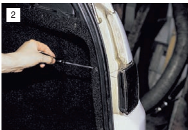
2 Для снятия фонаря отворачиваем четыре самореза обивки...
