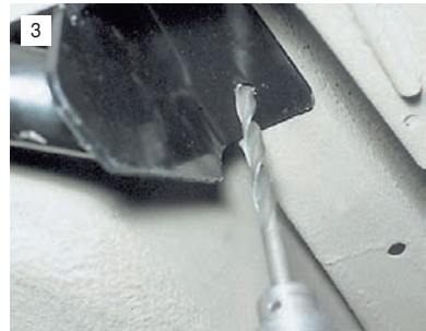
Сверлим в нижней полке лонжерона по месту другие два отверстия...
