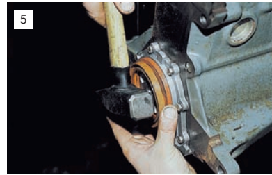
5 Используя старый сальник как оправку, запрессовываем новый сальник.
