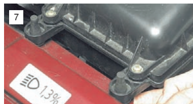
Вытаскиваем три резиновые опоры корпуса воздушного фильтра из отверстий в кузове и кронштейне.
