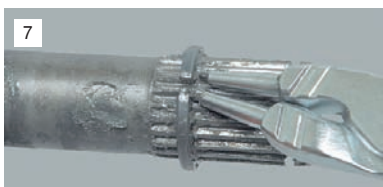
Разжимаем его щипцами и снимаем.
