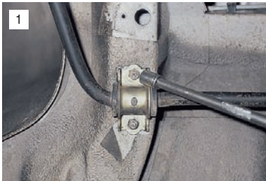
1 Головкой "на 13" отворачиваем гайку крепления скоб подушек...
