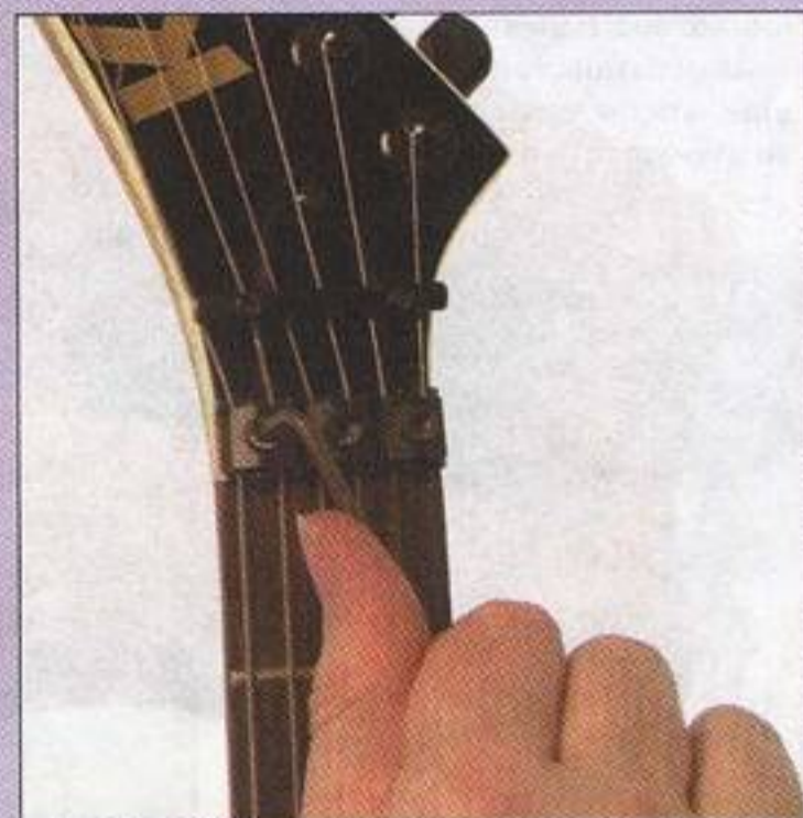
Чтобы ослабить гайки, поворачивайте четырехгранный ключ против часовой стрелки.
