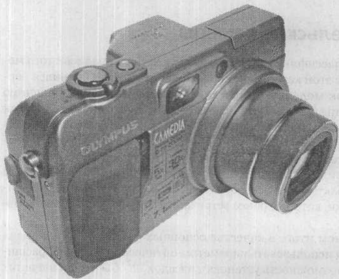
Рис. 3.5. Olympus C-70 Zoom (разрешение 3072×2304, объектив 35–190 мм, f/2.8 – f/4.8 )
