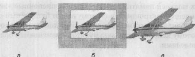
Рис. 3.2. Влияние коэффициента фокусного расстояния на изображение: а — изображение, формируемое объективом, рассчитанным на пленку 35 мм; б — часть изображения, которую «видит» ПЗС-матрица; в — изображение, генерируемое ПЗС-матрицей
