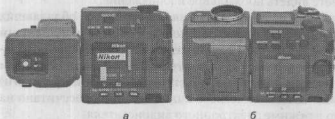
Рис. 2.36. Камера с «переламывающейся» конструкцией: а — положение при съемке; б — положение при транспортировке
