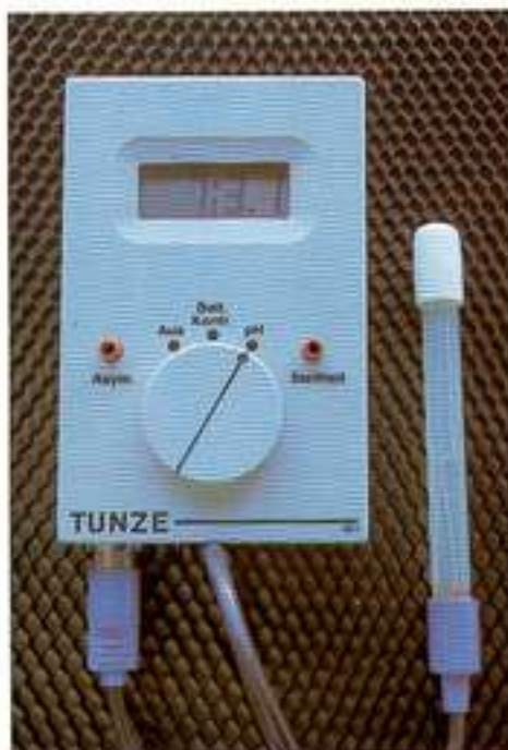
Электронные тестеры проводимости (в данном случае с цифровым индикатором) по размеру довольно малы, а потому удобны. Они разработаны специально для аквариумистов различными фирмами: «Tunze», «Dupla», «Stein», «Bischof» и другими.
