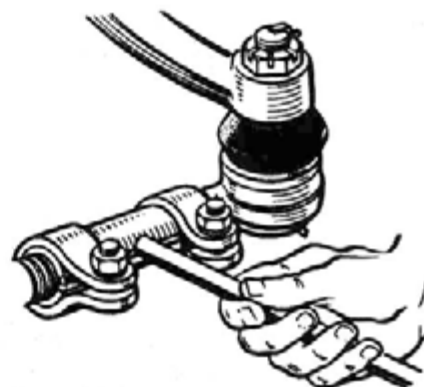
Рис. 141. Регулировка схождения колес
