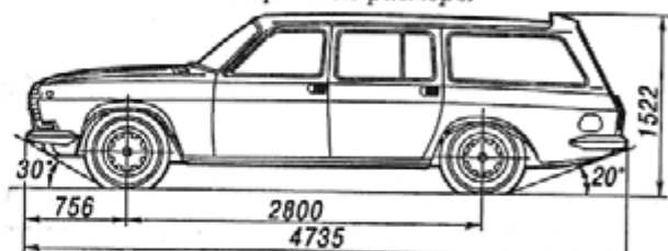
Рис. 3. Автомобиль ГАЗ-24-12 "Волга" и его габаритные размеры
