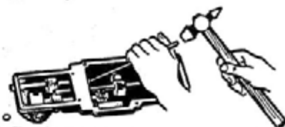
Рис. 107. Демонтаж штока включения I и II передач
