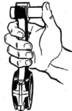
Рис. 66. Подбор поршневого пальца к шатуну
