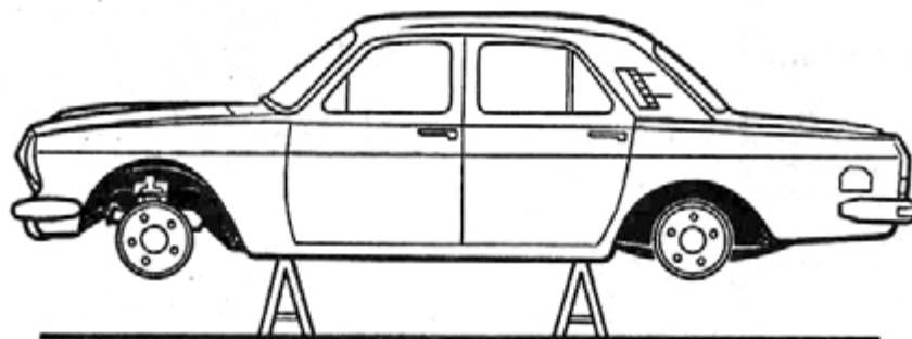
Рис. 8. Установка автомобиля на подставках
