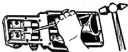
Рис. 106. Снятие головки штока включения III и IV передач
