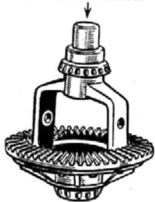
Рис. 135. Напрессовка подшипника дифференциала
