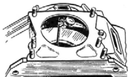
Рис. 58. Проверка concentricity отверстия картера сцепления с осью коленчатого вала приспособлением 24-У-114625
