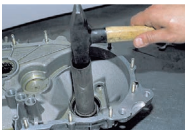
Подходящим отрезком трубы выбиваем из картера сцепления...
