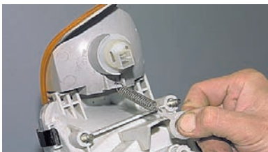
...расположение пружины крепления указателя поворота...
