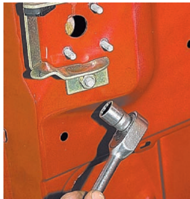
Головкой «на 13» отворачиваем две гайки шпилек крепления направляющей скобы замка...
