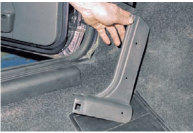
Снимаем переднюю накладку порога.
