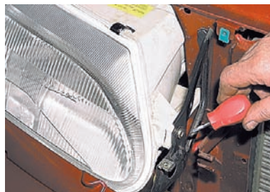
Крестообразной отверткой отворачиваем саморез крепления корпуса фары к кронштейну.
