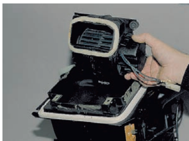
...и снимаем вентилятор.
