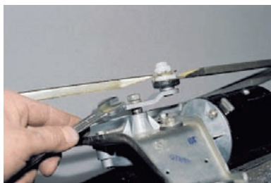
Ключом «на 13» отворачиваем гайку крепления кривошипа...
