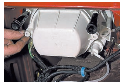
Отворачиваем два винта с пластмассовыми головками с левой и правой сторон крышки корпуса фары...
