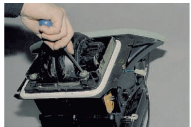
Крестообразной отверткой отворачиваем два винта крепления вентилятора к отопителю...
