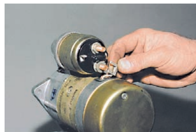
Снимаем наконечник провода.
