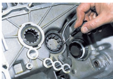
Отверткой извлекаем из сепаратора ролики переднего подшипника вторичного вала.
