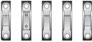
Метки на крышках коренных подшипников
