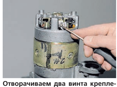
Отворачиваем два винта крепления наконечников проводов обмотки статора к щеткодержателям.
