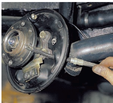
Вынимаем трос из отверстия щита тормозного механизма.
