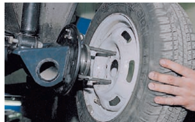
Равномерно затягивая винты, выпрессовываем ступицу.
