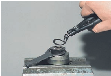
Щипцами разжимаем стопорное кольцо...
