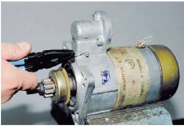
Расшплинтовываем ось рычага...
