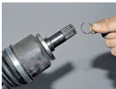
...и снимаем его со шлицевого конца корпуса внутреннего шарнира.
