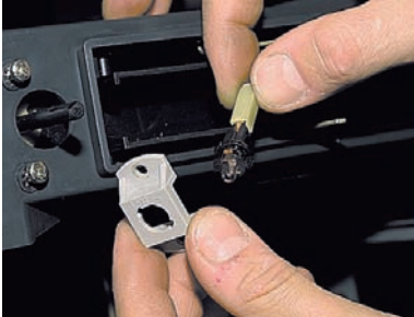
Повернув, выводим патрон лампы из отверстия в держателе.
