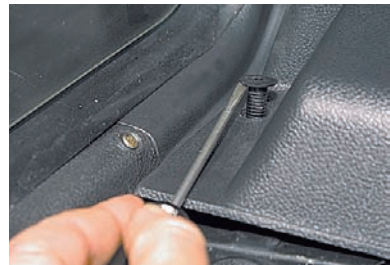
Также поддевая отверткой, вынимаем пистон.
