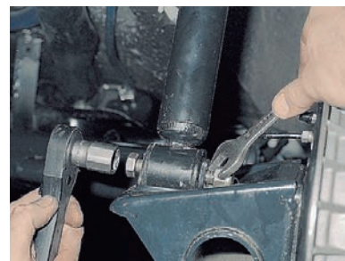
Головкой и ключом «на 19» отворачиваем гайку болта крепления амортизатора к балке.
