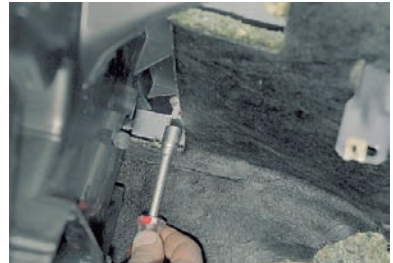
Головкой «на 10» отворачиваем четыре гайки крепления кожуха отопителя к кузову.
