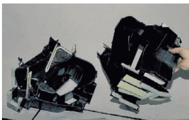
Разрезав уплотнитель по плоскости разъема, разделяем правый и левый кожухи отопителя.
