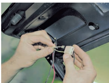
Пометив провода, вынимаем их из колодки.
