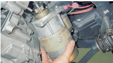
Аналогично снимаем стартер 29.3708.
