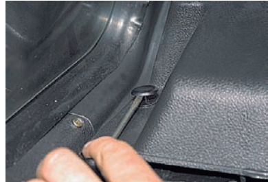
Поддеваем отверткой замок пистона...
