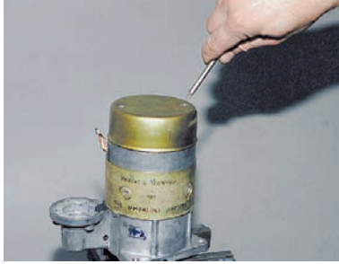
Крестообразной отверткой отворачиваем два винта защитного кожуха.
