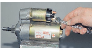
Ключом «на 10» отворачиваем гайку нижнего контактного болта.
