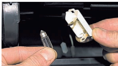
...и снимаем рассеиватель.
