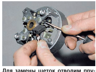
Для замены щеток отводим пружину и вынимаем щетку из направляющей.
