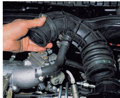
Снимаем воздушный шланг в сборе со шлангом вентиляции картера.
