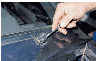
Поддев отверткой, снимаем защитный колпачок.
