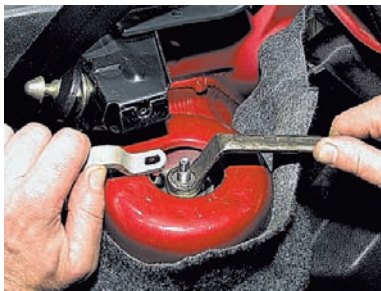
Накидным ключом «на 17» отворачиваем гайку штока заднего амортизатора, удерживая шток от проворачивания специальным ключом (или ключом «на 6»).
