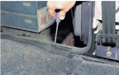
Отворачиваем три самореза крепления накладки порога задней двери и снимаем накладку.
