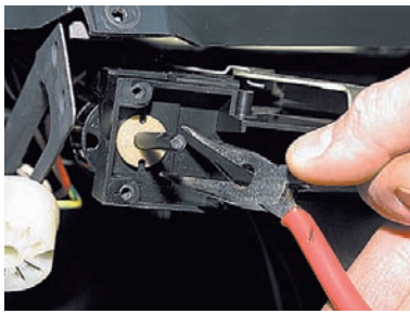
...пассатижами отворачиваем гайку с двумя пазами...
