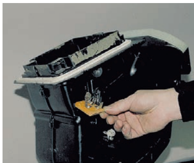
...снимаем резистор электродвигателя (резистор можно заметить, не снимая отопитель).
