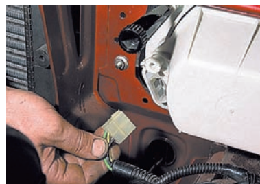
Отсоединяем колодку жгута проводов от корпуса фары.
