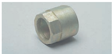
Ключ с восьмигранником «на 24» для разборки рулевого механизма
