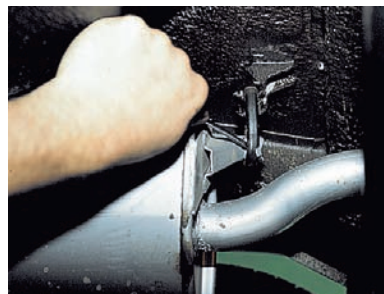
Отверткой отсоединяем от крючков подушки подвески основного глушителя спереди,
