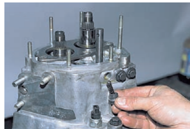
Вынимаем из гнезд пружины и шарики фиксаторов.
