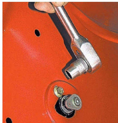
Головкой «на 8» отворачиваем болт крепления привода замка...
