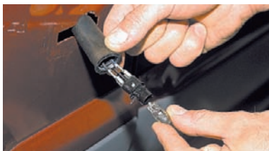
Потянув за колбу, вынимаем лампу.
