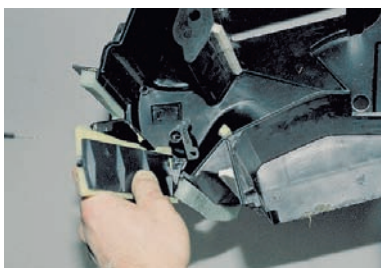
Выводим рычаг заслонки обдува ветрового стекла из отверстия наружного рычага привода и снимаем заслонку.
