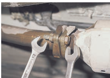
Ключом «на 17» отворачиваем гайки двух болтов заднего крепления нейтрализатора. Болты от проворачивания удерживаем ключом того же размера.
