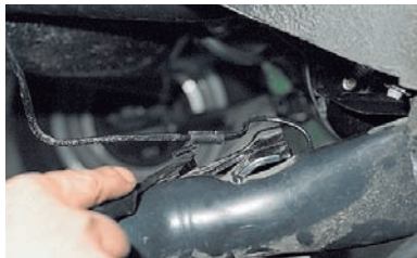
Отогнув скобу крепления, снимаем тормозную трубку.
