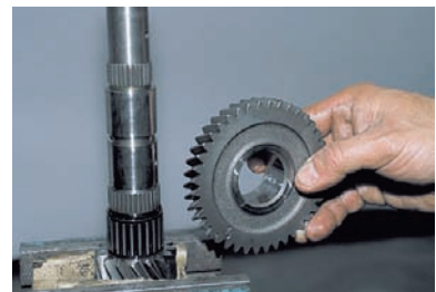
Снимаем ведомую шестерню I передачи.
