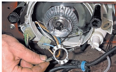
Повернув против часовой стрелки, снимаем прижимную пластину лампы.
