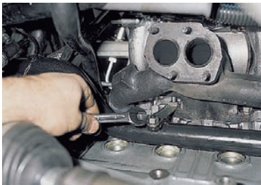
Ключом «на 13» отворачиваем верхнюю и ослабляем нижнюю гайки крепления кронштейна подводящей трубы насоса охлаждающей жидкости...
