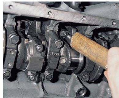
Упираясь деревянной ручкой молотка в разъем нижней головки шатуна, проталкиваем его вверх до выхода поршня из цилиндра...
