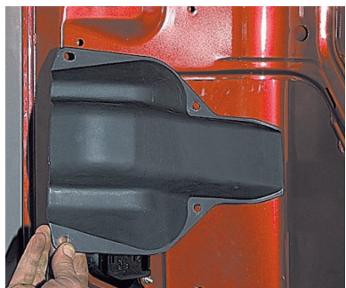
...и снимаем пластмассовую крышку замка.
