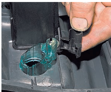
Снимаем направляющую патрона лампы подсветки.
