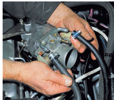
Ослабляем хомуты крепления и снимаем шланги подвода и отвода охлаждающей жидкости.
