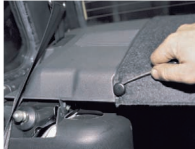
Поддеваем отверткой замок пистона крепления полки к правой боковине...
