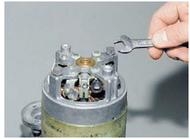
Ключом «на 10» отворачиваем два стяжных болта.
