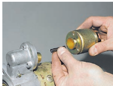
Снимаем тяговое реле и пружину.
