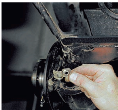
Снимаем скобу крепления троса.
