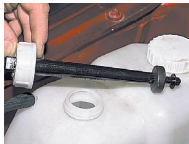
...отворачиваем крышку-держатель датчика и снимаем датчик.
