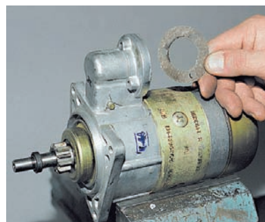
Соединение тягового реле и передней крышки уплотнено прокладкой.
