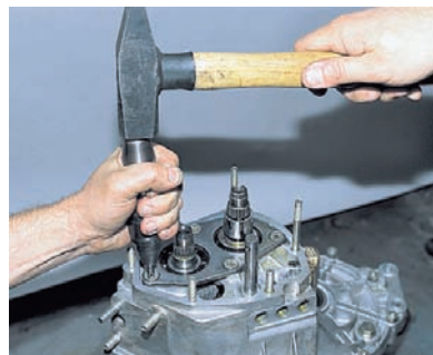
Ударной крестообразной отверткой отворачиваем четыре винта крепления упорной пластины.
