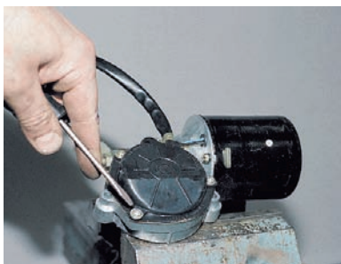
Шлицевой отверткой отворачиваем три винта крепления защитного колпака.
