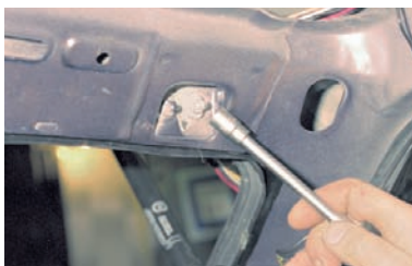
Головкой «на 10» отворачиваем по две гайки крепления каждой петли двери задка...
