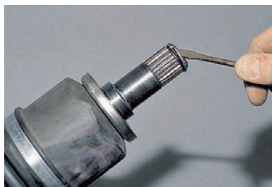
Поддеваем отверткой стопорное кольцо, которым привод фиксируется в коробке передач,
