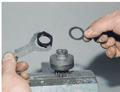
...и снимаем рычаг с кольцом отводки.
