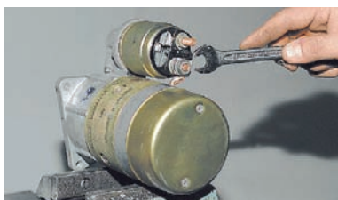
Ключом «на 13» отворачиваем гайку нижнего контактного болта.
