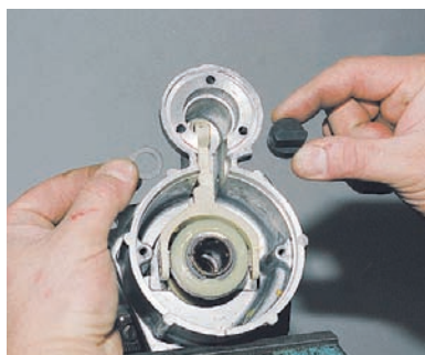
Из передней крышки извлекаем резиновую заглушку и шайбу.
