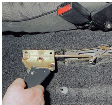
Сдвинув рычаг вперед, снимаем его вместе с кронштейном и тягой.
