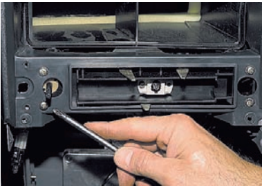
Крестообразной отверткой отворачиваем четыре самореза крепления блока управления отопителем.
