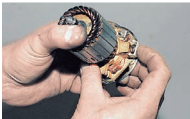
Ставим пружины и фиксируем их скобами.
