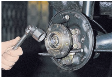
Головкой «на 30» отворачиваем гайку.
