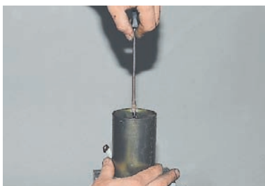
...опускаем корпус на заднюю крышку. Смазываем шестерни планетарного редуктора смазкой ШРУС-4.
