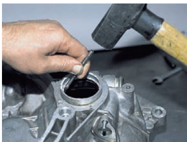
Через бородок наносим удары в торец наружного кольца подшипника дифференциала...
