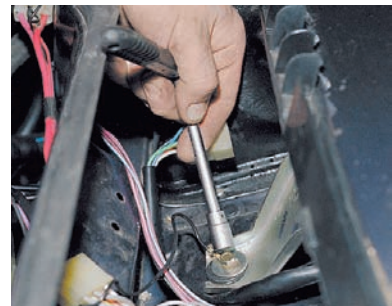
Головкой «на 10» отворачиваем болт крепления стеклоочистителя к кузову.
