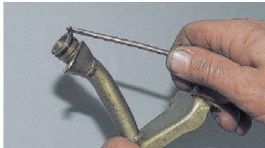
Поддев отверткой, снимаем уплотнительное кольцо трубки.
