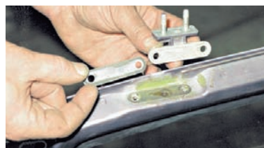
Снимаем петлю двери и прокладку.
