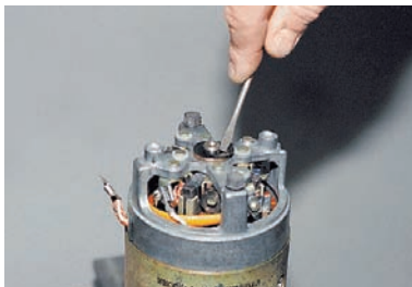
Поддеваем отверткой и снимаем стопорную шайбу и расположенную под ней шайбу.
