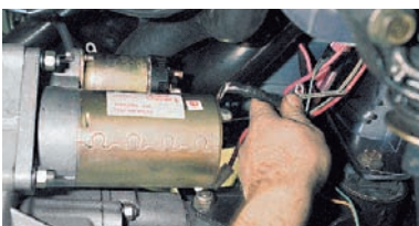
...и снимаем наконечник провода.
