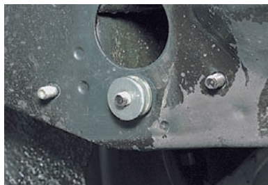
Снимаем бампер с автомобиля.
