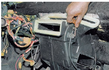
Освобождаем скобу-держатель крепления оболочки тяги заслонки обдува ветрового стекла к кожуху отопителя.
