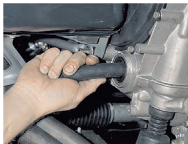
Для этого подойдет фиксатор из отрезка резинового шланга соответствующего диаметра. Левый привод демонтируем аналогично правому,
