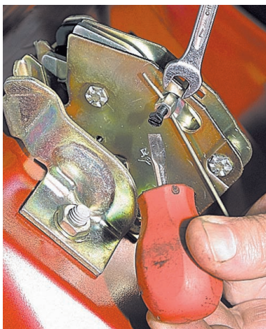
Удерживая ключом «на 7» резьбовую втулку, шлицевой отверткой отворачиваем стопорный винт тяги...
