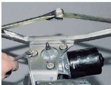
Ключом «на 10» отворачиваем три болта крепления мотор-редуктора к кронштейну...
