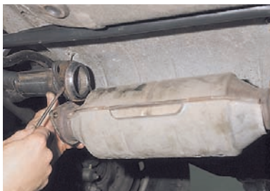
Поддеваем отверткой уплотнительное кольцо из графитосодержащего материала...
