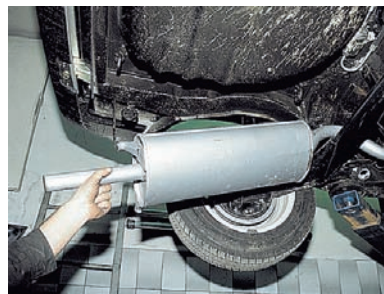
Снимаем глушитель. Устанавливаем основной глушитель в обратной последовательности.
