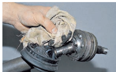
Протираем и очищаем от старой смазки торцевую часть шарнира.
