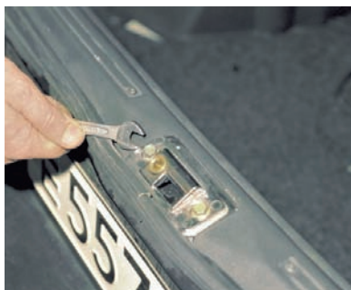
Ключом «на 10» отворачиваем два болта крепления фиксатора...
