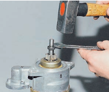
Установив стартёр вертикально, ударяем молотком по рожковому ключу «на 14» и спрессовываем ограничительное кольцо.
