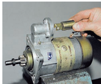
Вынимаем якорь тягового реле.
