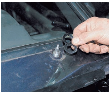
Снимаем пластмассовую и резиновую шайбы. Аналогично снимаем второй поводок стеклоочистителя.
