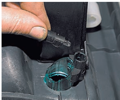
Вынимаем патрон лампы подсветки прикуривателя.
