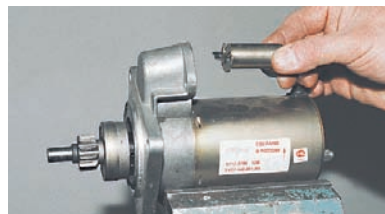
Снимаем якорь тягового реле.
