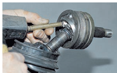
Через выколотку из мягкого металла сбиваем шарнир, нанося удары по торцу обоймы.
