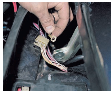
Под ним расположен наконечник провода «массы».
