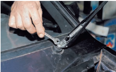
Ключом «на 10» отворачиваем гайку крепления поводка стеклоочистителя.
