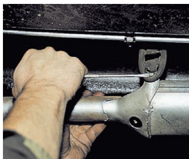
Отсоединяем две подушки подвески дополнительного глушителя...
