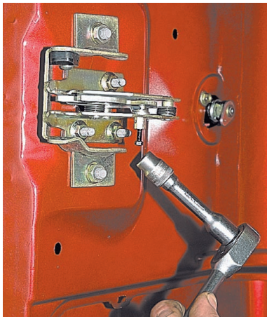
Головкой «на 10» отворачиваем три гайки шпилек крепления замка к крышке багажника...
