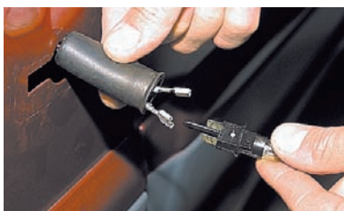
При замене патрона отсоединяем от его контактов наконечники проводов.
