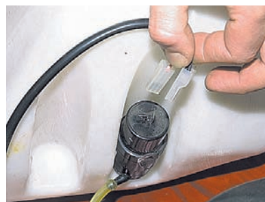
...отсоединяем от его выводов колодки проводов.
