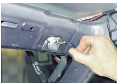
...и снимаем «минусовой» провод.
