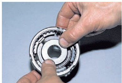
Сдвигаем ступицу внутри скользящей муфты синхронизатора...
