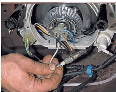
...вынимаем ее за патрон из рефлектора фары.
