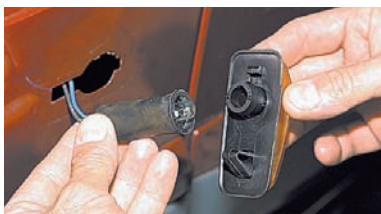
Вынимаем патрон с лампой из плафона.
