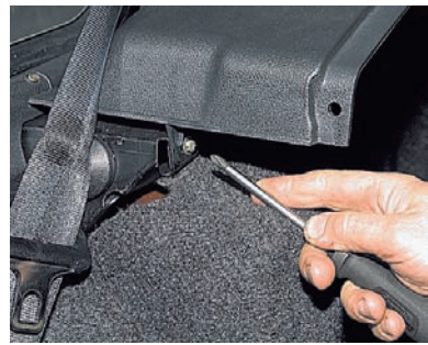
Крестообразной отверткой отворачиваем саморез крепления боковины задней полки (показана правая боковина).
