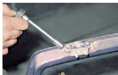
Головкой «на 10» отворачиваем два болта крепления петли.
