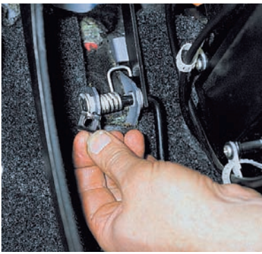
...снимаем стопорную скобу.
