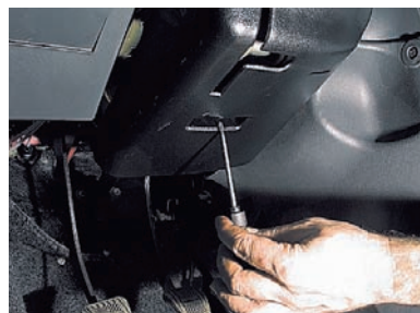
...и два самореза крепления нижнего кожуха к кронштейну рулевой колонки.
