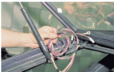
Вынимаем электропроводку. Отсоединяем газонаполненные упоры. Помощник придерживает дверь задка. Отгибаем задний край обивки крыши (см. «Обивка крыши», с. 160).
