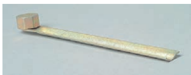
Ключ с восьмигранником «на 17» для регулировки рулевого механизма
