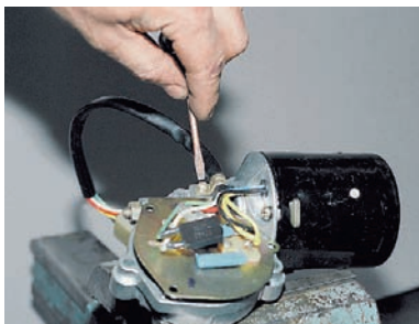
Отвернув шлицевой отверткой винт крепления хомута проводов,
