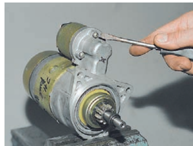
Отворачиваем три винта крепления тягового реле.
