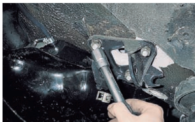
Головкой «на 17» отворачиваем три гайки крепления кронштейна к кузову...
