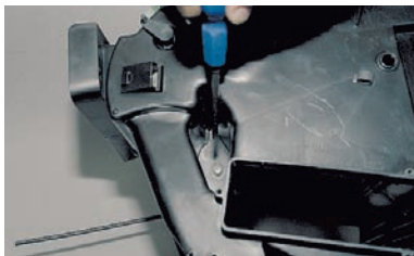
...и крестообразной отверткой отворачиваем саморез с правой стороны в углублении.
