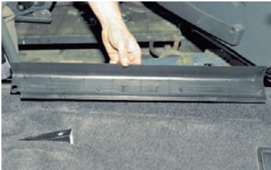
Снимаем накладку порога передней двери.
