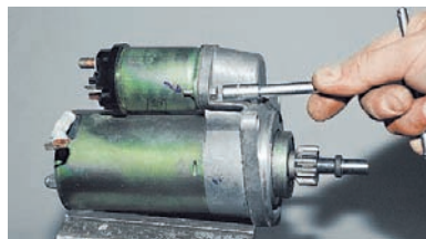
Головкой «на 8» отворачиваем два болта крепления тягового реле...
