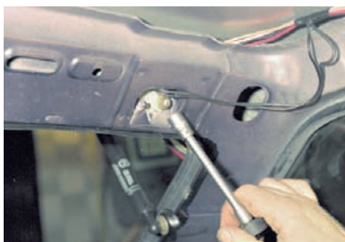
Головкой «на 10» отворачиваем гайку...
