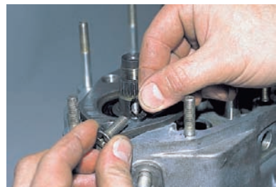
Самоотворачивание винтов предотвращают специальные стопорные шайбы.
