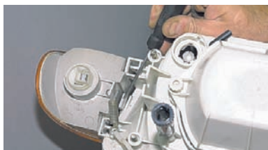
...и освобождение защелки его крепления отверткой. Устанавливаем указатель поворота в обратной последовательности.
