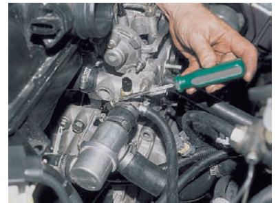
Крестообразной отверткой ослабляем хомуты и снимаем все шланги с выпускного патрубка головки блока цилиндров.
