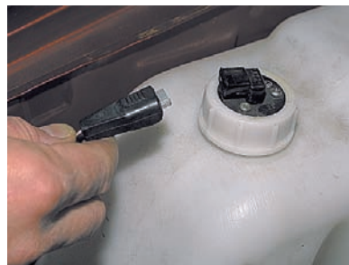
...отсоединяем колодку проводов,
