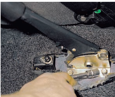
Головкой «на 10» отворачиваем четыре болта крепления кронштейна рычага к полу.
