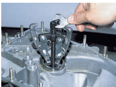
Зацепив съемником буртик наружного кольца подшипника,
