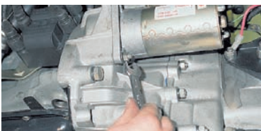
Ключом «на 13» отворачиваем три гайки крепления стартера к картеру сцепления.
