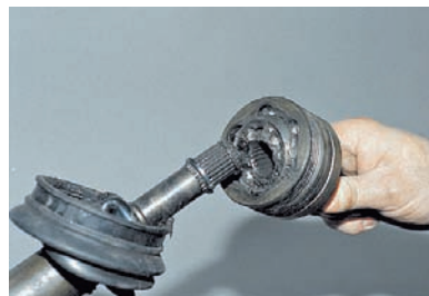
Снимаем шарнир. Шарнир на валу фиксируется стопорным кольцом, расположенным в проточке на конце вала.
