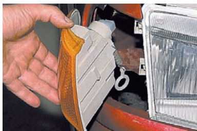
...и снимаем указатель, выводя его фиксаторы из кронштейнов корпуса фары. Для наглядности на снятой фаре показываем...
