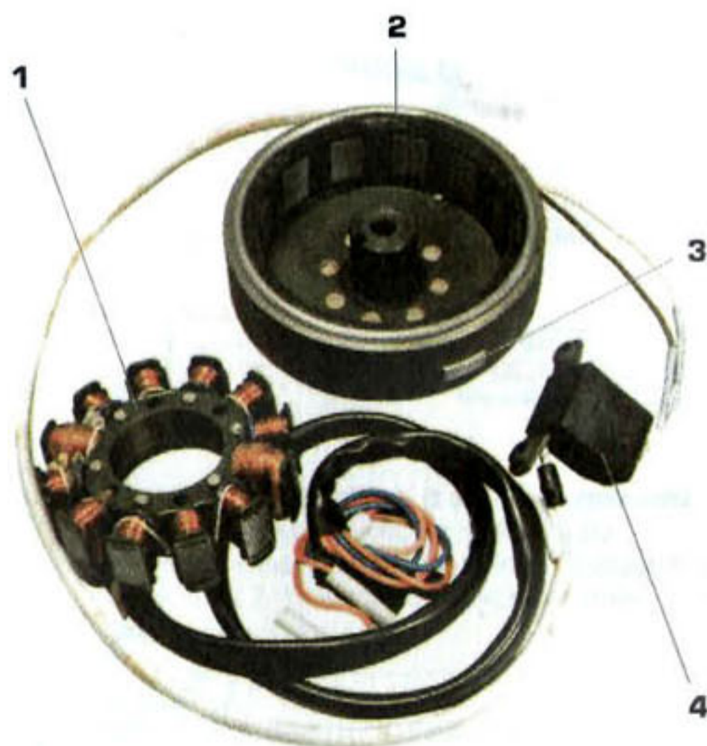
Рис. 3.4. Маховичный генератор переменного тока («Иж-Планета-5»): 1 — статор с катушками, закрепляемыми на крышке картера; 2 — маховичный ротор с постоянными магнитами; 3 — магнит датчика системы электронного зажигания; 4 — датчик
