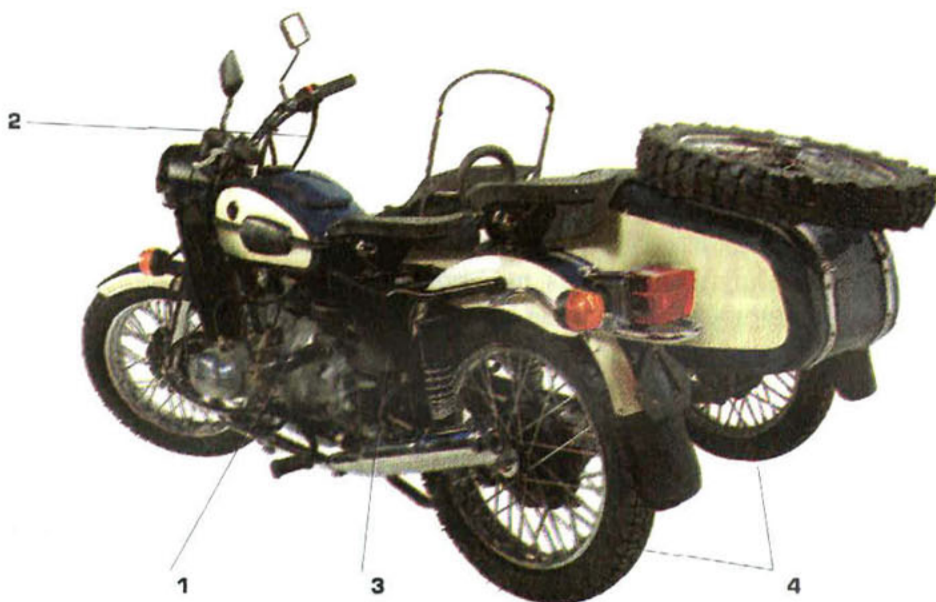
Рис. 6.2. Подготовка мотоцикла к зимней эксплуатации: 1 — применение в двигателе и КП зимнего масла; 2 — смазка тросов; 3 — повышение плотности электролита аккумуляторной батареи; 4 — замена шин на зимние и применение шипов
