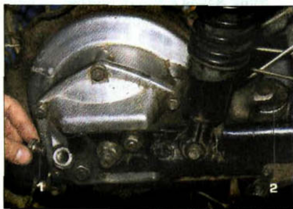
Рис. 4.21. Обслуживание карданной передачи («Урал»): 1 — заливная и контрольная пробка заднего моста; 2 — пресс-масленка крестовины
