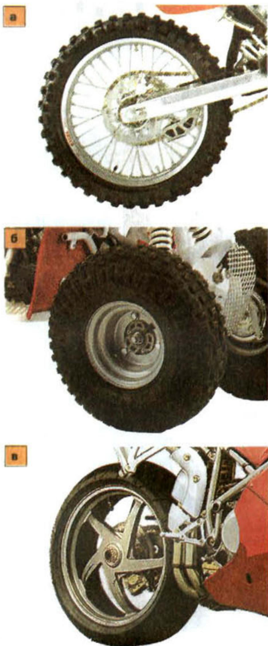
Рис. 5.22. Мотоциклетные колеса: а — спицованное; б — штампованное; в — литое
