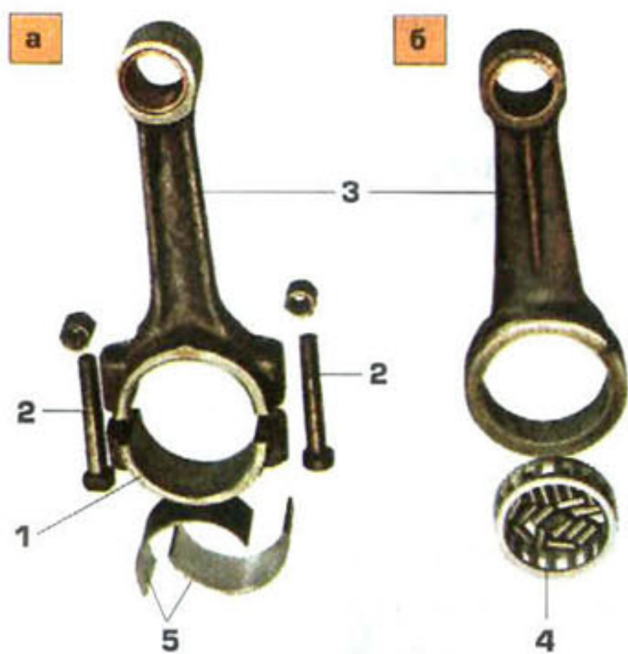
Рис. 2.6. Шатуны: а — с разъемной нижней головкой («Днепр»); б — с неразъемной нижней головкой («Урал»); 1 — крышка шатуна; 2 — шатунный болт; 3 — шатун; 4 — сепаратор подшипника нижней головки шатуна и ролики; 5 — вкладыши
