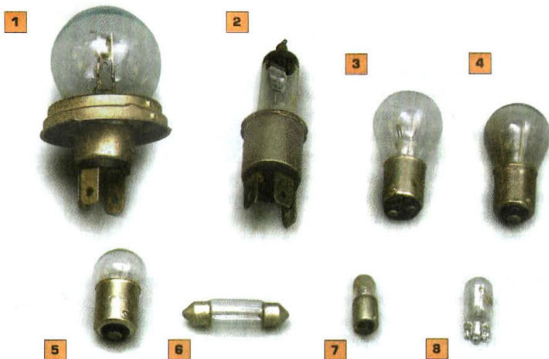
Рис. 3.23. Лампы, применяемые на мотоциклах: 1 — лампа дальнего/ближнего света; 2 — галогенная лампа дальнего/ближнего света; 3 — двухнитевая лампа; 4 — однонитевая лампа сигнала торможения; 5 — лампа габаритного света заднего фонаря; 6 — пальчиковая лампа заднего фонаря; 7 — лампа стояночного света фары и подсветки панели приборов; 8 — бесцокольная лампа панели приборов
