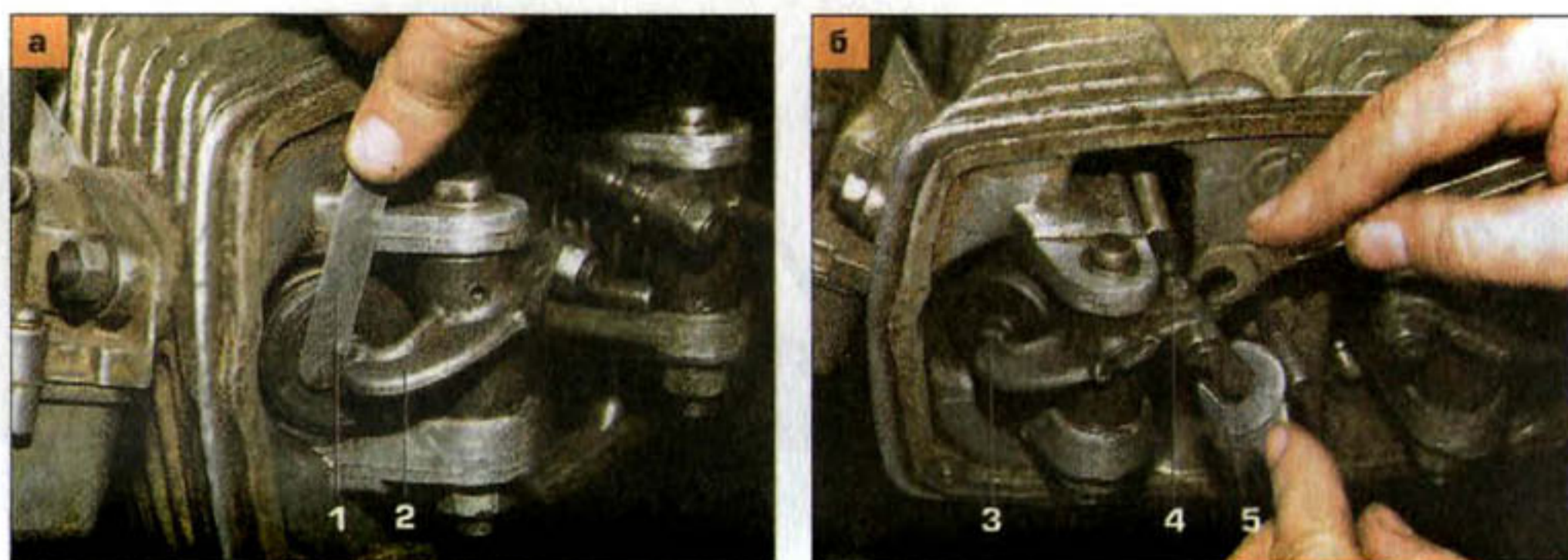
Рис. 2.32. Регулировка клапанного зазора двигателя мотоцикла «Днепр»: а — проверка щупом зазора между клапаном и коромыслом в положении поршня в ВМТ (такт сжатия); б — установка нужного зазора поворотом регулировочного болта [контргайка отпущена]; 1 — щуп; 2 — коромысло; 3 — торец клапана; 4 — регулировочный болт; 5 — контргайка
