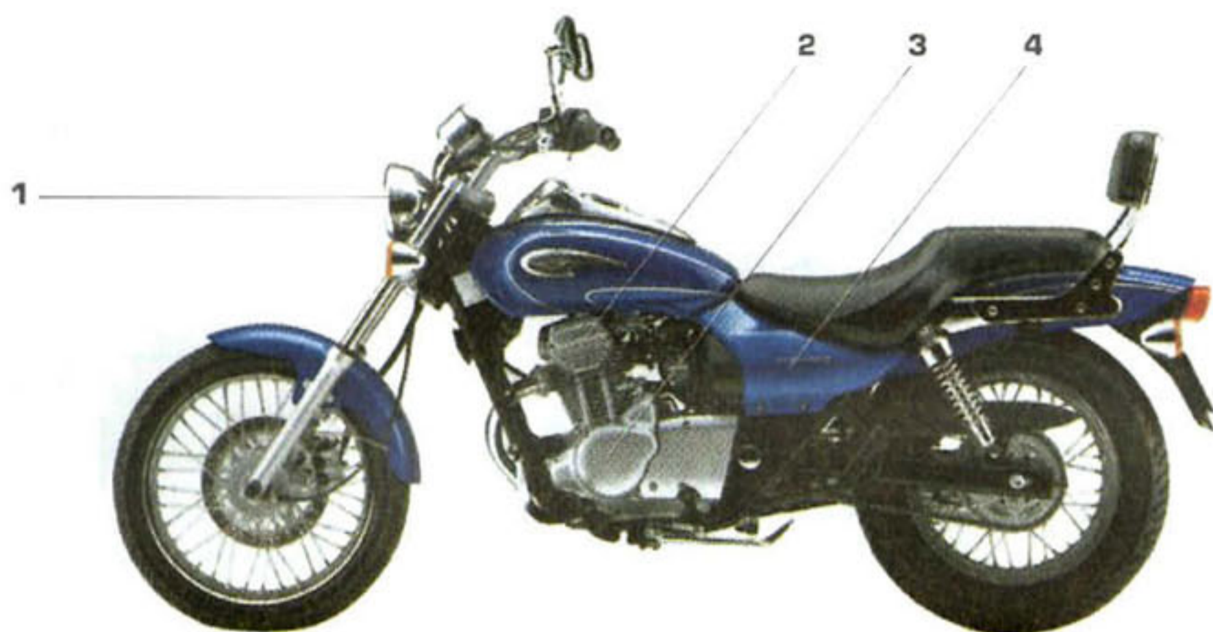
Рис. 3.30. Обслуживание электрооборудования мотоцикла: 1 — регулировка фары; 2 — контроль состояния свечей; 3 — очистка контактных колец генератора; 4 — проверка плотности и уровня электролита в аккумуляторной батарее
