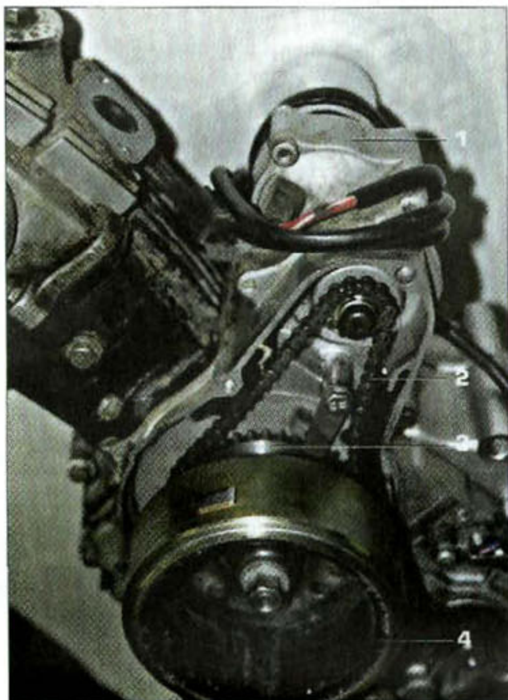
Рис. 4.12. Система электропуска с цепным приводом («Хонда-125»): 1 — электростартер; 2 — цепная передача; 3 — муфта свободного хода; 4 — ротор генератора
