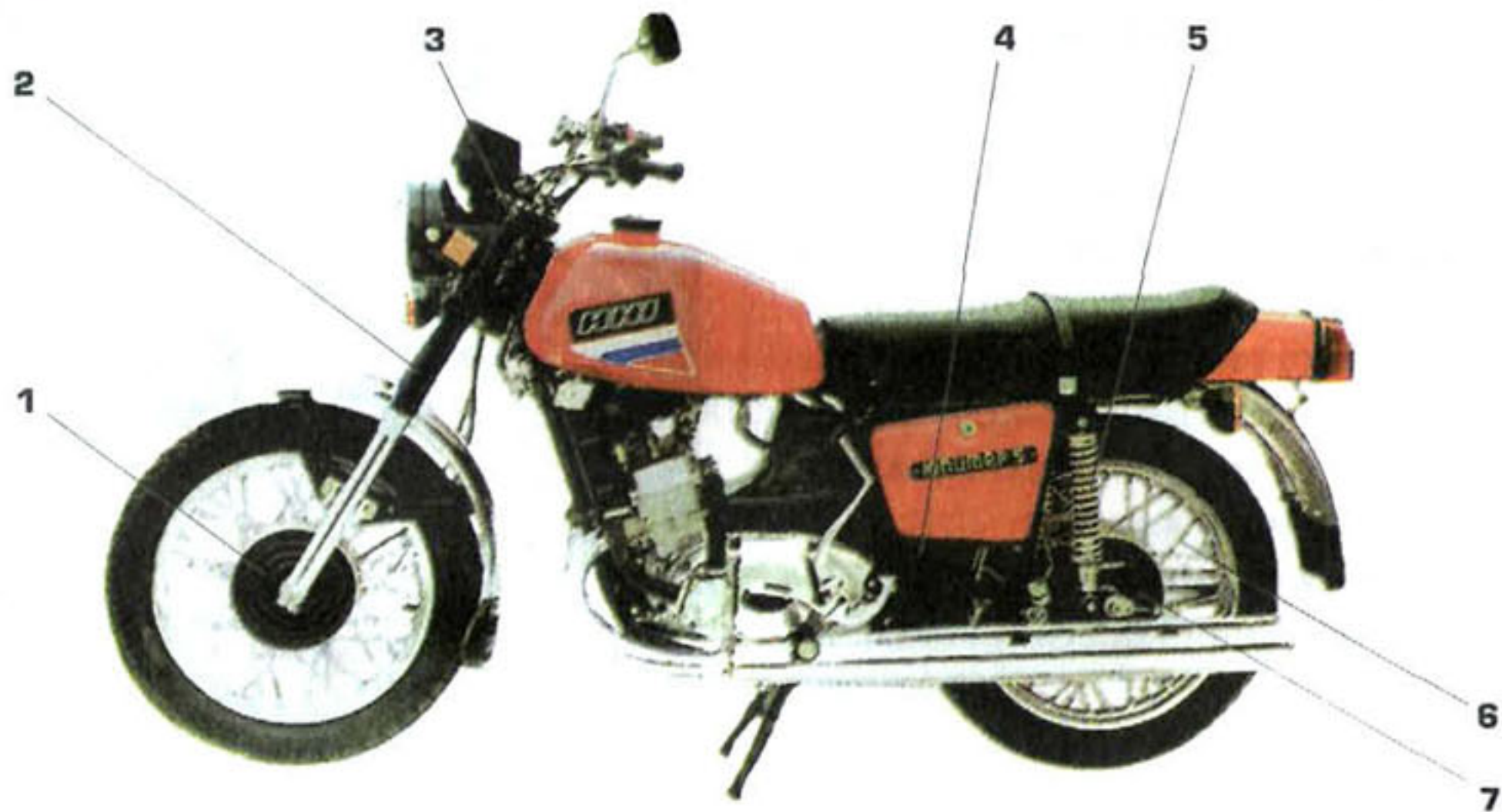
Рис. 5.30. Обслуживание ходовой части мотоцикла («Иж-Юпитер-5-01»): 1 — очистка и замена колодок переднего тормоза; 2 — замена масла в передней вилке; 3 — смазка и регулировка подшипников рулевой колонки; 4 — смазка оси маятника; 5 — замена масла в задних амортизаторах; 6 — контроль натяжения спиц; 7 — очистка и замена колодок заднего тормоза
