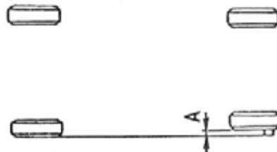
Рис. 254. Проверка установки левого переднего колеса для езды по прямой
