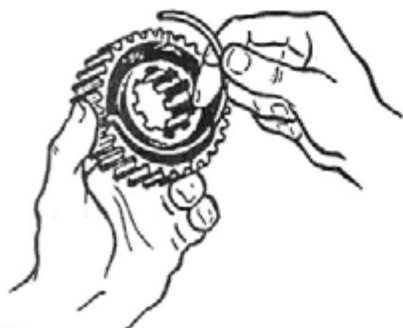
Рис. 200. Установка пружин синхронизатора
