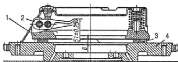
Рис. 176. Регулировка рычагов выключения сцепления:
