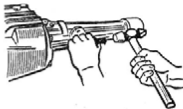
Рис. 194. Выпрессовка оси блока шестерен
