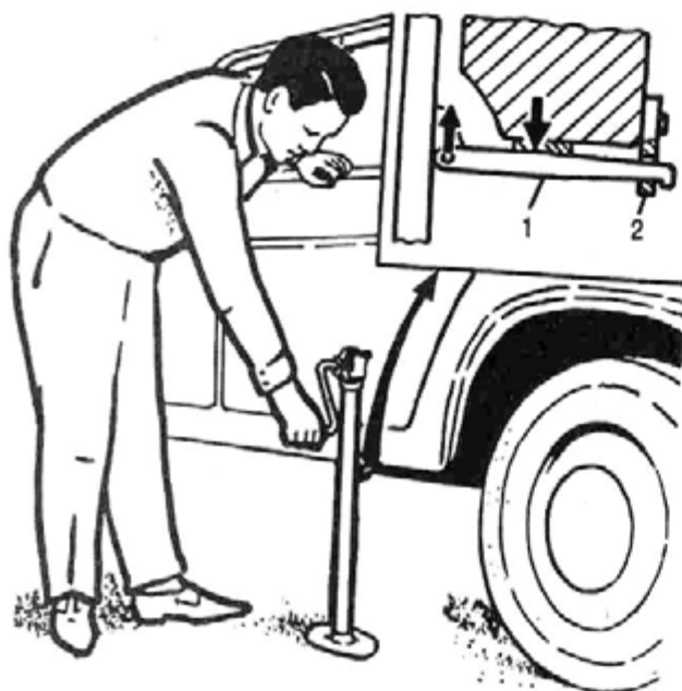
Рис. 9. Применение домкрата 1 - лапа домкрата; 2 - упор
