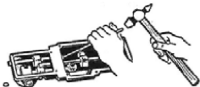
Рис. 199. Демонтаж штока включения 1-ой и 2-ой передач
