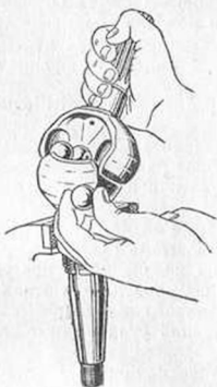
Рис. 83. Положение кулаков шарнира, в котором устанавливается последний шарик.
